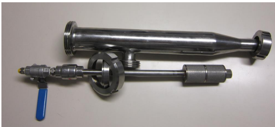
Figura 15: iniettore utilizzato per l'introduzione dell'azoto nel trattamento di stripping.
