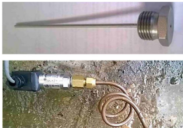
Figura 35: Pozzetti per l'inserimento dei sensori di temperatura e di pressione
