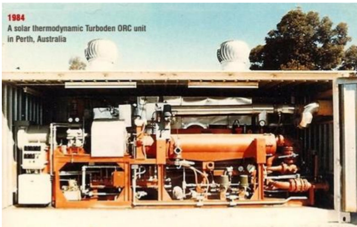
Figura 8: Esempio di impianto ORC solare sviluppato da Turboden nel 1984 [12]
