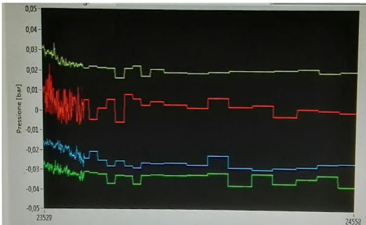
Figura 51: Grafico delle pressioni acquisite durante la prova a vuoto
