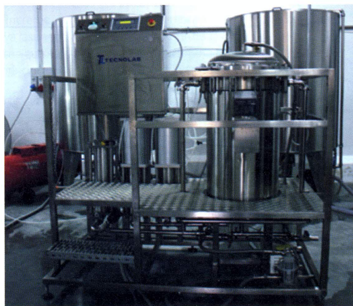
Figura 1 - Estrattore e fusore Timatic (Tecnolab, Spello, PG)
