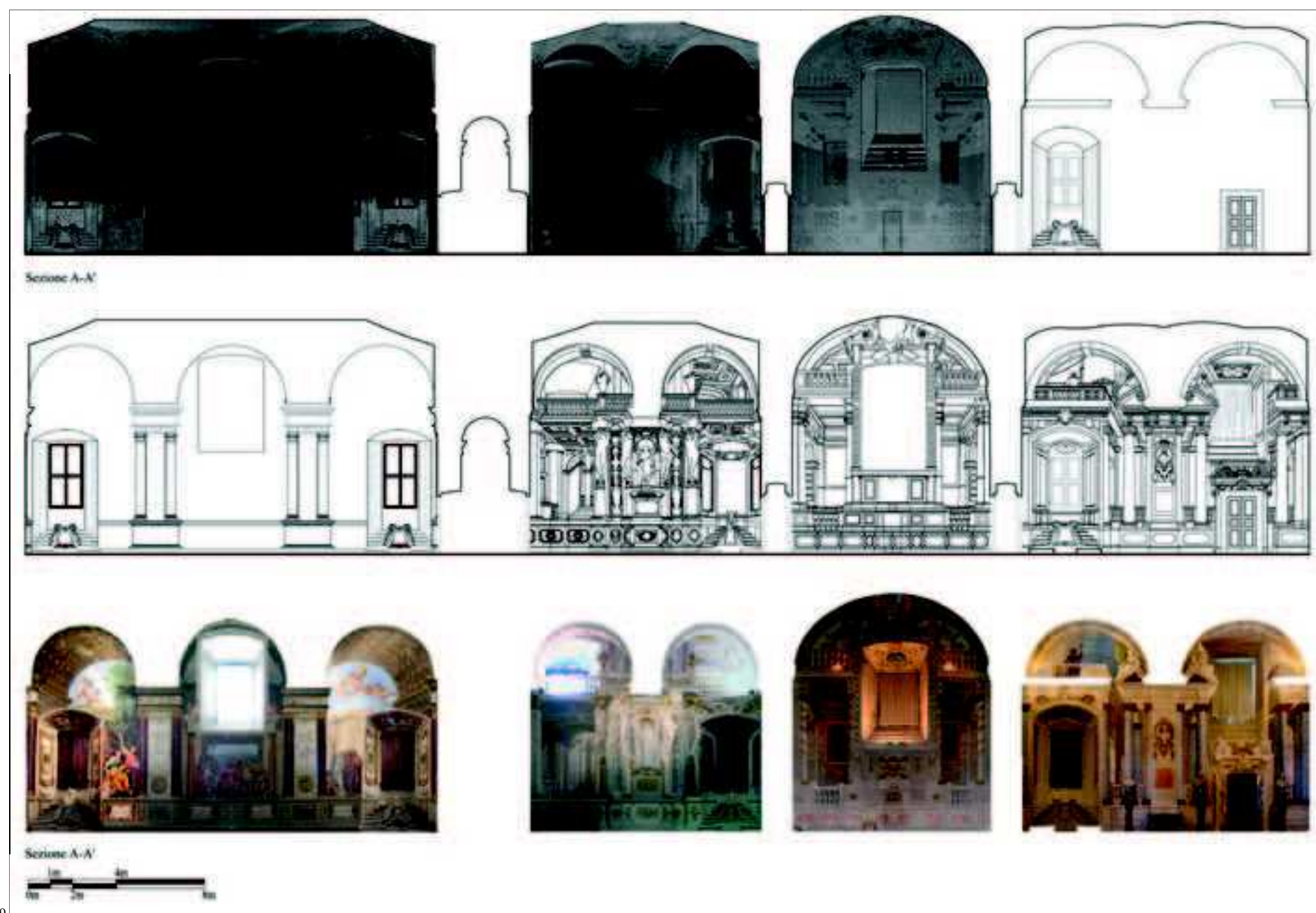
39. Sezione longitudinale A-A'; profili delle sezioni con inseriti le viste della nuvola di punti in proiezione parallela delle pareti; la restituzione a "filo di ferro" delle decorazioni presenti sulle pareti; la vista dei fotopiani
