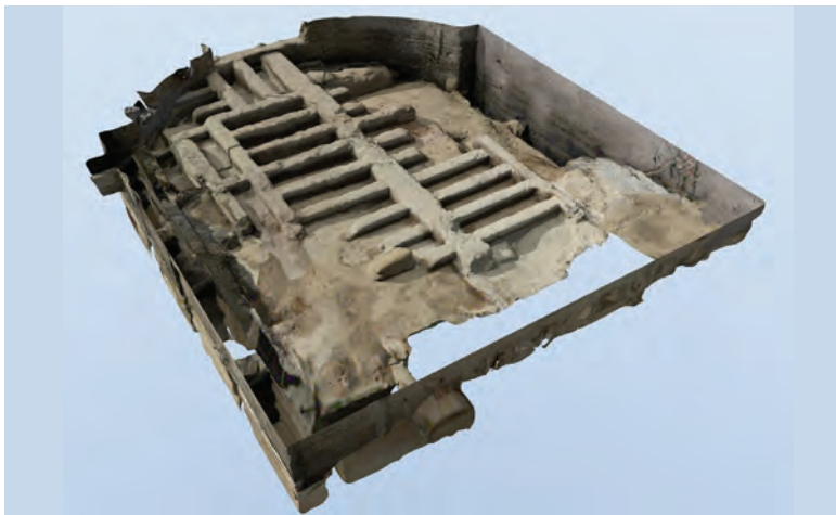
Fig. 7: Modello di superfici generato ed ottimizzato a partire dal rilievo 3D laser scanner, versione in fase di editing in Maxon Cinema 4D.
