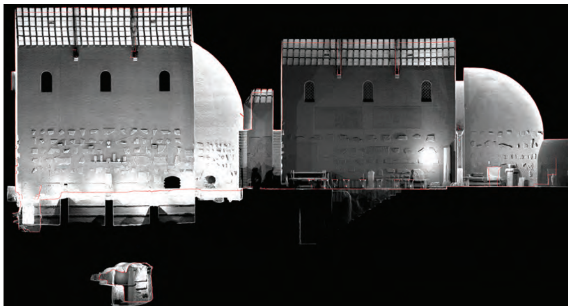
Fig. 5: Sezione longitudinale del complesso della basilica di San Silvestro dalla nuvola di punti.
