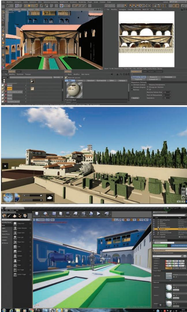
Desde el modelo NURBS hasta la creación de un modelo interactivo: en la parte superior de la fase de mapeo de modelos en el software de Cinema 4D, en el centro de creación del software Lumion, debajo de la visualización Unreal Engine Editing Mode para diseñar los elementos interactivos del modelo.
