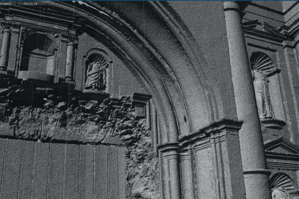
1. Il modello hi-poly costruito a partire dai dati forniti dalla scansione laser. L'ingente quantità di dati dà luogo a modelli estremamente pesanti e di difficile gestione.
