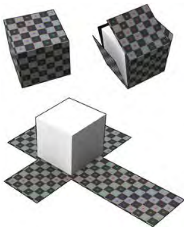
Fig. 22 Sviluppo (unwrapping) delle superfici di un cubo. In questo modo è possibile stabilire una corrispondenza biunivoca tra i punti del cubo e i punti della mappa UV generata a seguito di questa operazione.
