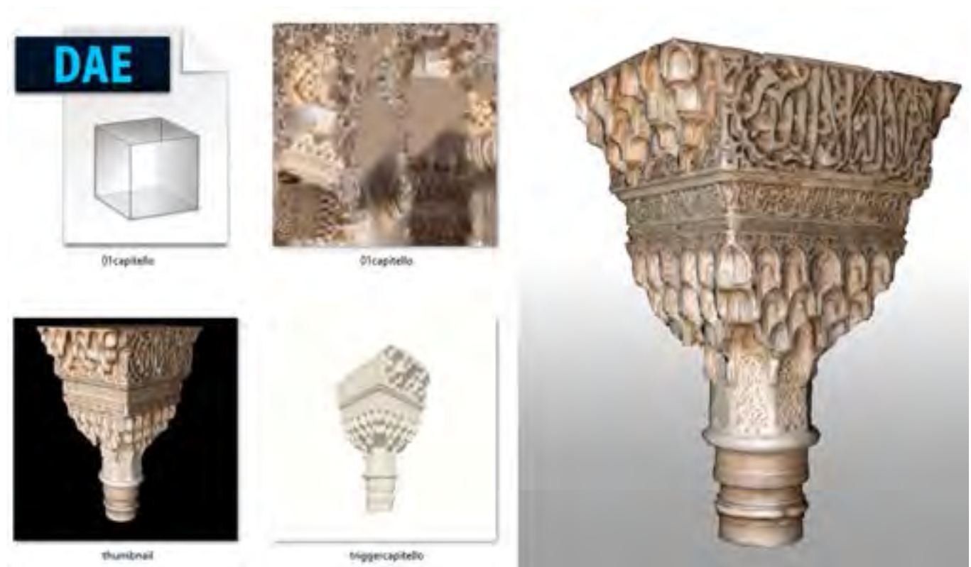
Fig. 56 Materiali contenuti all’interno della pacchetto .rar necessario al funzionamento dell’applicativo AURASMA: un file del modello in formato .DAE, una texture, un’immagine ‘thumbnail’ e un’immagine ‘trigger’. Si osserva a destra una anteprima della visualizzazione del capitello nella sua versione finale.
