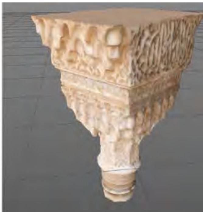
Fig. 55 Modello mesh di un capitello visualizzato nelle modalità 'gouraud shading (linee)' e 'quick shading' all'interno di Cinema. Si noti come una texture ad alta definizione sopprimerà a tutte le mancanze qualitative di modello poligonale possiede. Il procedimento per l'importazione del modello 3D all'interno dell'applicativo di Realtà Aumentata richiede un basso numero di poligoni.
