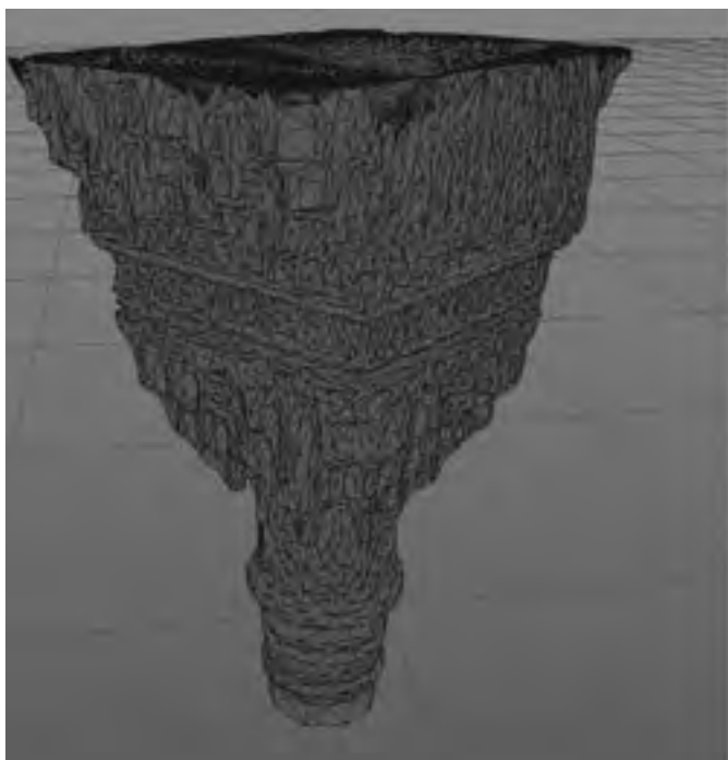
Fig. 55 Modello mesh di un capitello visualizzato nelle modalità 'gouraud shading (linee)' e 'quick shading' all'interno di Cinema. Si noti come una texture ad alta definizione sopprimerà a tutte le mancanze qualitative di modello poligonale possiede. Il procedimento per l'importazione del modello 3D all'interno dell'applicativo di Realtà Aumentata richiede un basso numero di poligoni.
