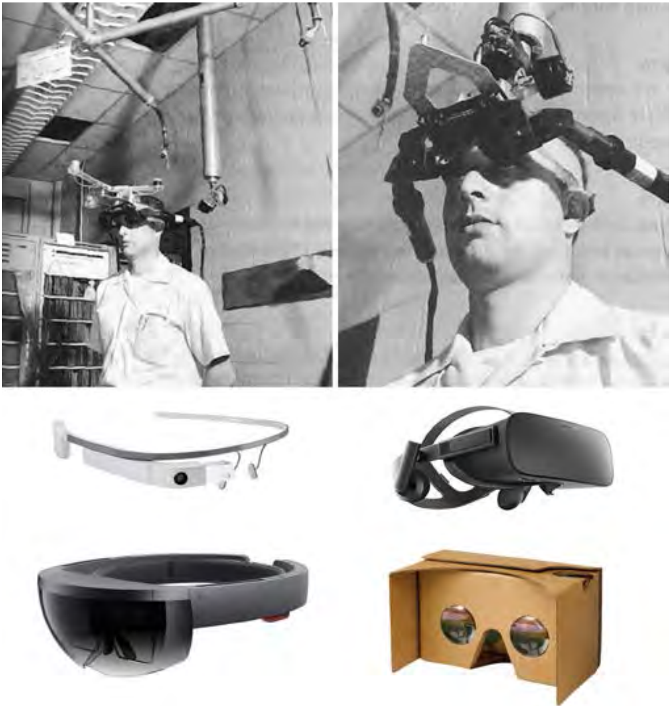
Fig. 23 In alto 'The sword of Damocle', invenzione del 1966 del primo dispositivo HMD (Head-mounted Display) di Bob Sproull. Sotto (in senso orario) è possibile vedere i dispositivi più evoluti della stessa 'tipologia': Google Glass, OculusRift, HoloLens e una semplice Cardboard di cartone.
