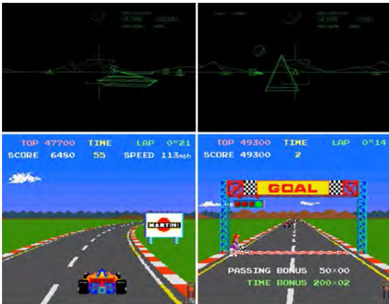
Fig. 8 (sopra) Primi esempi di grafica tridimensionale nei videogiochi. In alto 'Battlezone' di Atari dove gli elementi sono visualizzati in modalità wireframe; sotto nel gioco 'Pole Position' di Namco, un videogioco arcade di simulazione di guida automobilistica dove l'effetto tridimensionale è ottenuto grazie ad una visualizzazione prospettica dell'ambiente di gioco.
