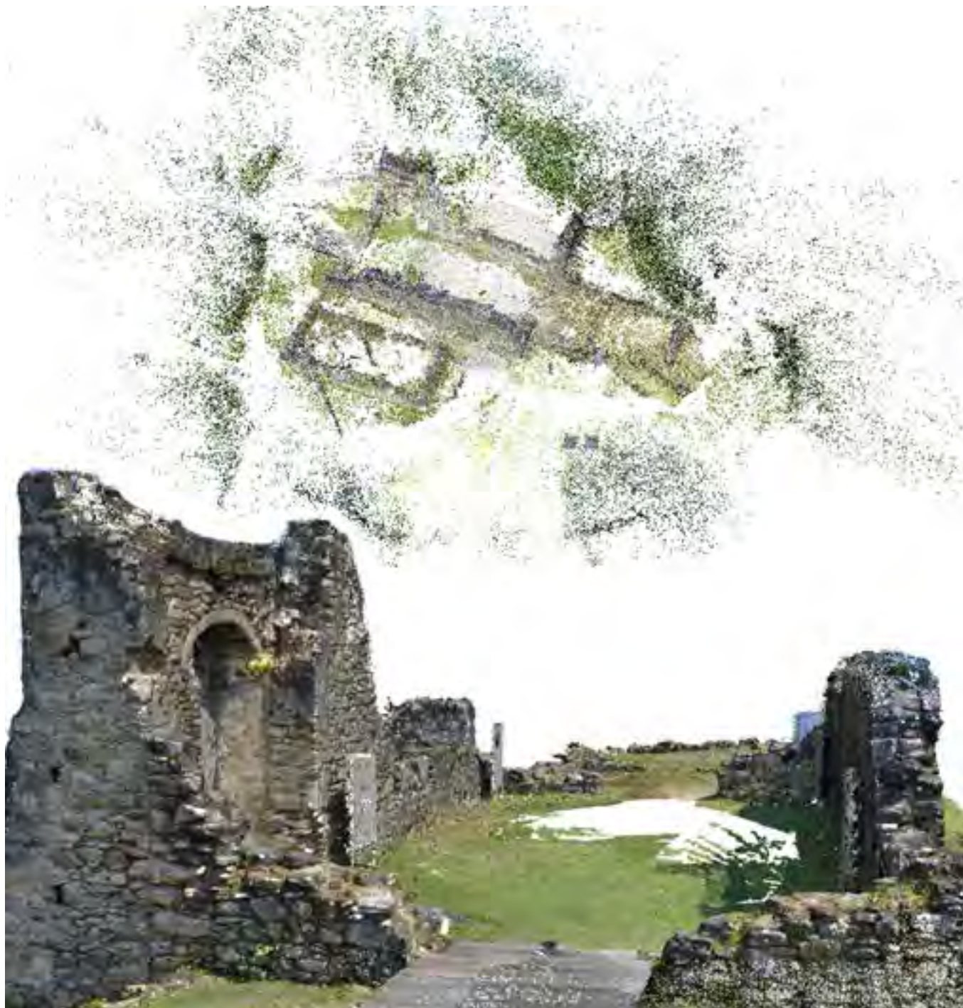
Fig. 17 Esempio di sorgenti derivate dal rilievo digitale tramite metodologie Structure from Motion. La nuvola di punti che deriva inizialmente è costituita da un basso numero di punti ma può essere 'densificata' attraverso alcune operazioni. Ad esempio all'interno del software Agisoft Photoscan è possibile costruire una 'dense cloud' su cui poi lavorare per la realizzazione della mesh poligonale.
