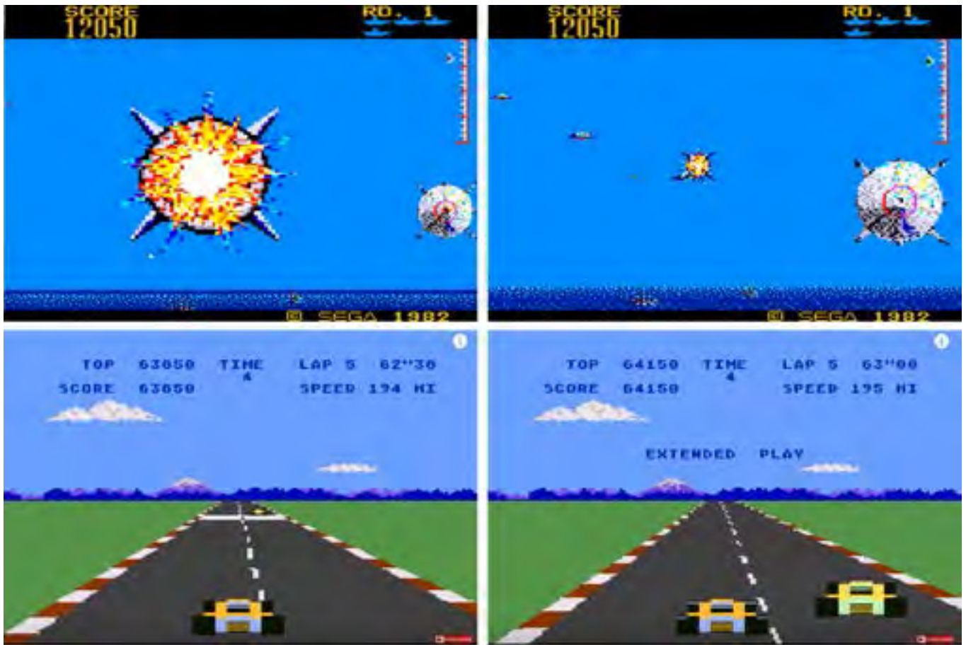
Fig. 25 Esempi di videogiochi in cui viene utilizzata la tecnica dello 'sprite scaling'. Nel gioco Subroc3D (sopra) i bagliori che simulano le esplosioni si ingrandiscono e rimpiccioliscono in base alla distanza del giocatore. Lo stesso avviene per le automobili nel gioco Pole Position (sotto).
