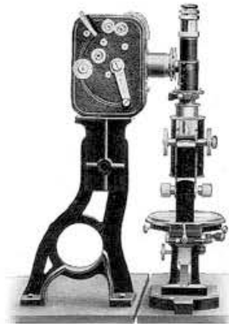
Mikroskopaufsatz 811 mit Universalkinamo 5439
