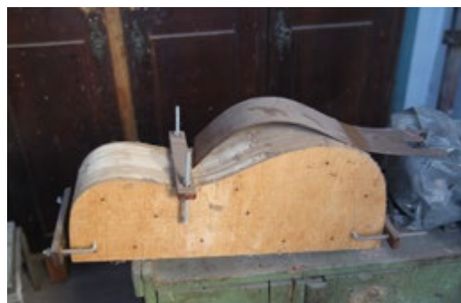
03 Dima per la curvatura delle casse armoniche, nel laboratorio del falegname liutaio Antonio Celso. Foto A. Ferreira dos Santos
