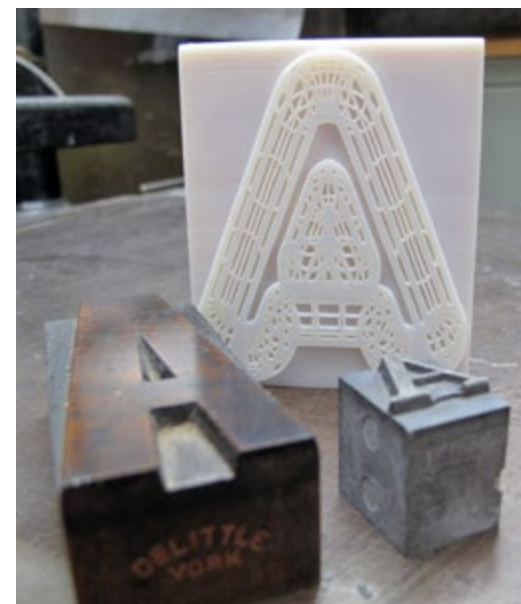
09 New North Press, A23D: a 3D-printed letterpress font, lettera "a" confrontata con lettere in legno e piombo
