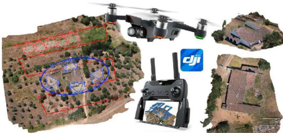
Figura 5. Sulla sinistra le due metodologie di acquisizione del dato riservate al solo monastero. Al centro il drone (Spark DJI) con il relativo software (DJI GO 4) e radiocomando. Sulla destra due viste del modello 3D, finale, ottenuto
