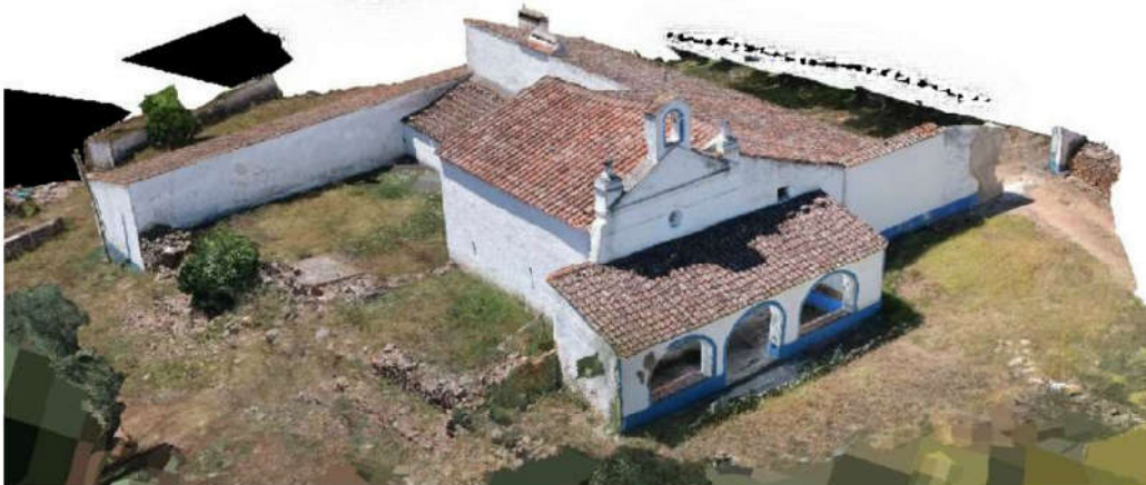
Figura 8. Vista del modello texturizzato ottenuto integrando il dato laser con le foto acquisite da drone e da terra
