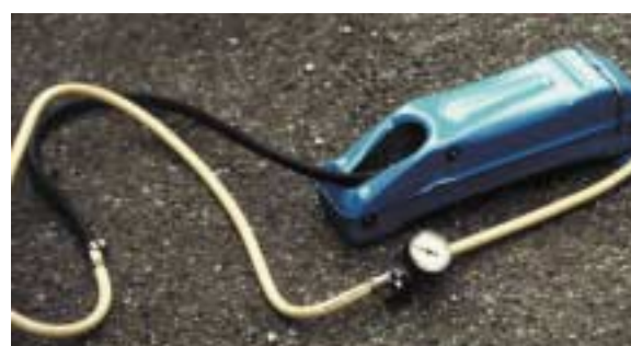
Fig. 7 - Pompa per il ripristino della pressione nella campana di compensazione della pompa
