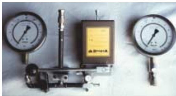
Fig. 2 - Un tipo di torchio idraulico per il controllo dei manometri
