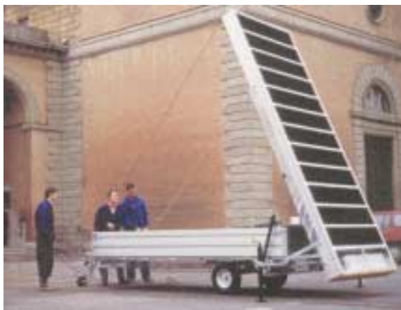
Fig. 28 - Il carrello con la parete lamellare in fase di sollevamento, tutte le attrezzature sono contenute nel pianale di carico sotto la parete
