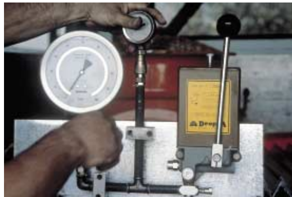
Fig. 35 - Esempi di torchi idraulici per il controllo della funzionalità dei manometri
