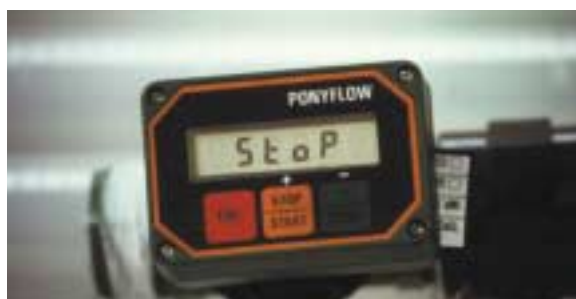
Fig. 9 - Flussimetro in dotazione al cantiere per il controllo della pompa
