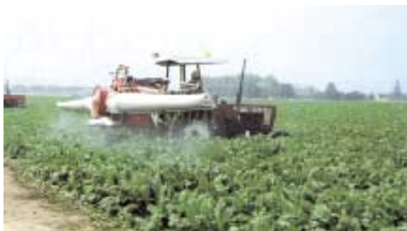
Fig. 12 - Barre con polverizzazione meccanica (tramite pressione) e trasporto per mezzo dell'aria
