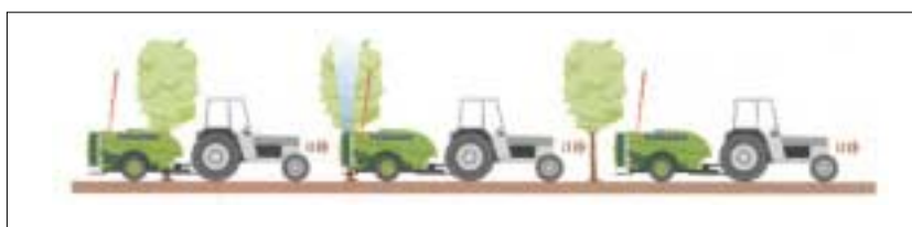
Fig. 16 - Sistema "spot spraying" DETECTA della TECNOMA, il principio del funzionamento è lo stesso di un apparecchio fotografico automatico, un rilevatore ottico percepisce le variazioni di intensità luminosa
