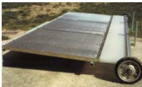
Fig. 5 - Il piano scanalato captante per il controllo della distribuzione nelle barre irroratrici
