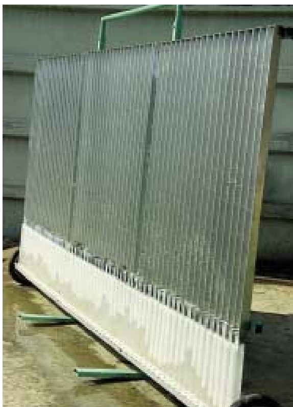
Fig. 29 - Piano captante orizzontale
