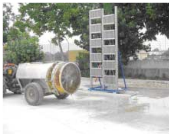
Fig. 3 - Operazioni di controllo della distribuzione mediante una parete captatrice a lamelle verticali
