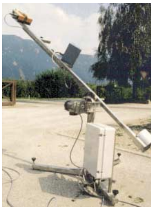
Fig. 48 - Il cantiere di controllo della distribuzione verticale Timetronic. Particolare del fotometro e della fonte luminosa montati sullo stesso asse
