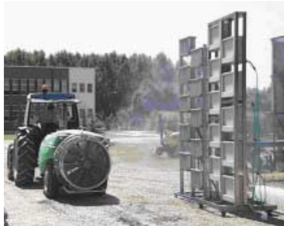
Fig. 1 - Prove di confronto di pareti captatrici presso l'Istituto Sperimentale per la Meccanizzazione Agricola ISMA
