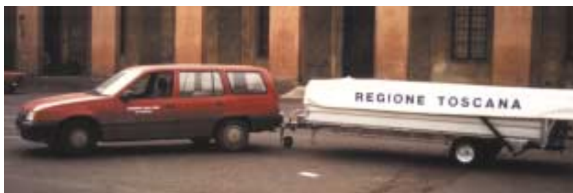
Fig. 11 - Il carrello contenente l'intero Cantiere di controllo delle irroratrici
