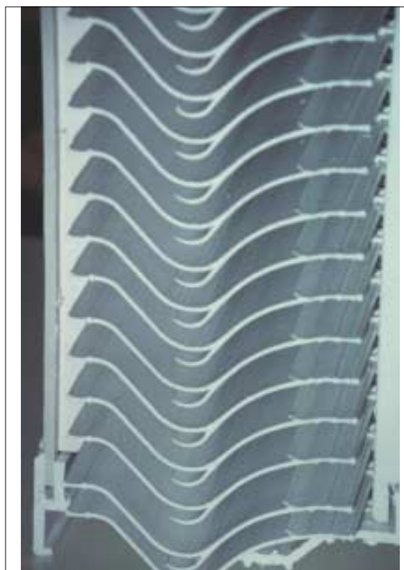
Fig. 3 - Profili lamellari per la separazione aria-gocce
