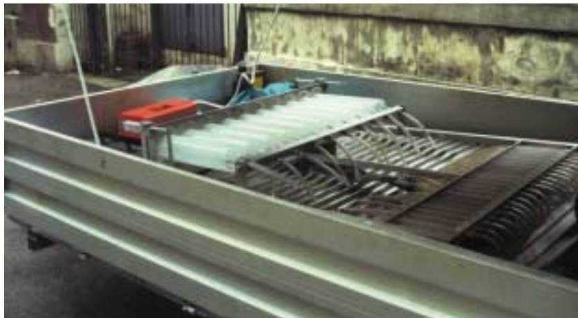
Fig. 10 - L'interno del carrello contenente l'intero Cantiere di controllo delle irroratrici
