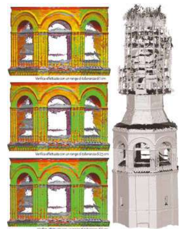
Fig. 13 Verifica di affidabilità dei rilievi digitali per l'elaborazione dei modelli 3D
