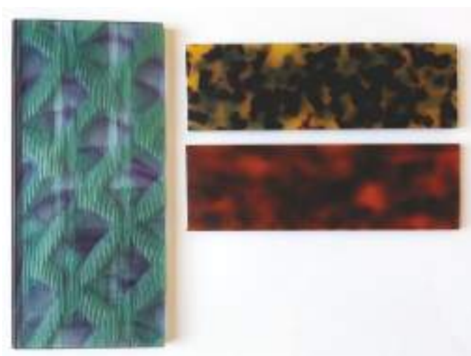
01. Lastre in acetato di cellulosa, tagliate con misure standard per essere inserite nelle macchine a controllo numerico, rappresentano lo scarto solido dell'occhialeria | Cellulose acetate sheets, cut to standard sizes for insertion in CNC machines, represent the solid waste from the eyewear industry. Anna Colonna
