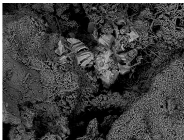
Fig. 7. Torre Zozzoli (TA). Immagine al SEM di un campione di pietra di un blocco del cantonale sinistro del prospetto ovest. I cristalli di Halite (NaCl) si dispongono nelle cavità e nelle porosità aperte. Le cristallizzazioni saline si presentano di tipo idiomorfo (tridimensionale). Ricontrate calciti aciculari in fase di cristallizzazione secondaria (sovrapposti all'halite).
