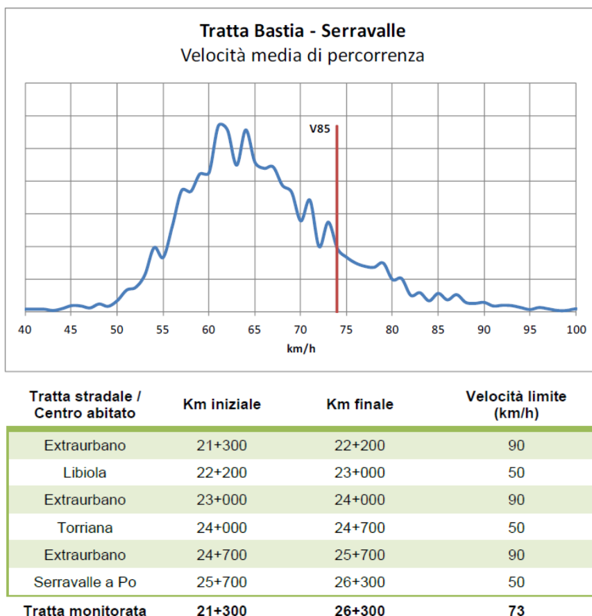
Figura 6.13 - Distribuzione delle velocità sulla tratta Bastia-Serravalle a Po e limiti di velocità normativi lungo l'intera tratta di ispezione. Estratto dal rapporto ispettivo
