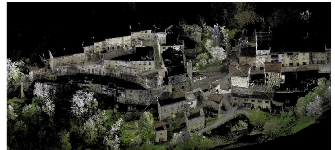
Fig. 2 - Rilievo del borgo fortificato di Lierna (nuvola di Punti).
