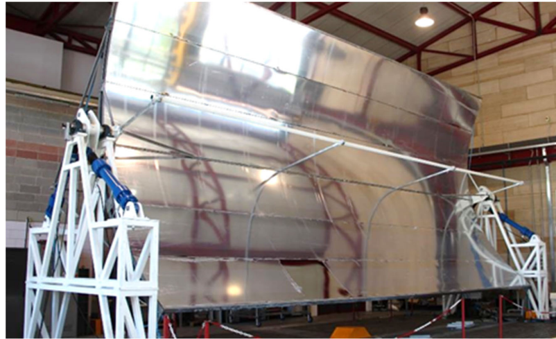
Figure 12. PTC CSP2.0 prototype testing at Politecnico di Milano.
