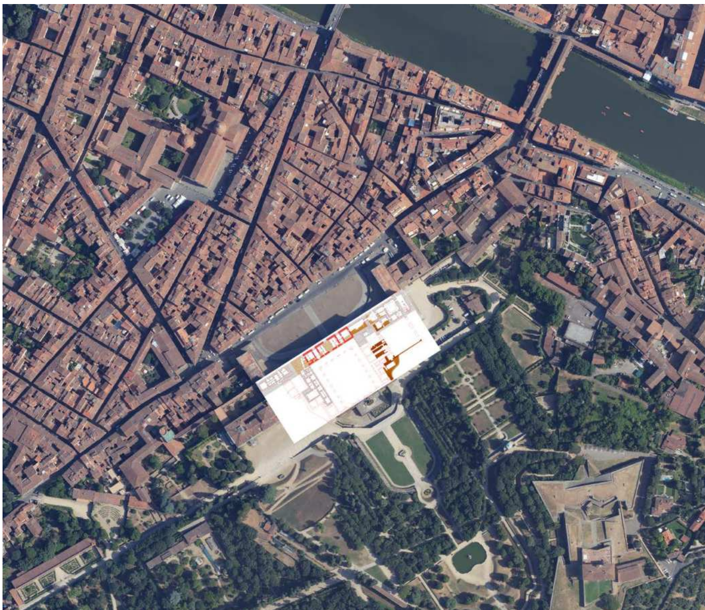
Fig. 11 - Inserimento della pianta di Palazzo Pitti nell'ortofoto; si evidenzia il nucleo originario del palazzo (in rosso) e la presenza di roccia nell'ala nord-ovest (marrone) (immagine di base da Google Earth). Insertion of the plan of Palazzo Pitti in the ortho-photo; the original nucleus of the building (in red) and the presence of rock in the north-west wing (brown) are highlighted.
