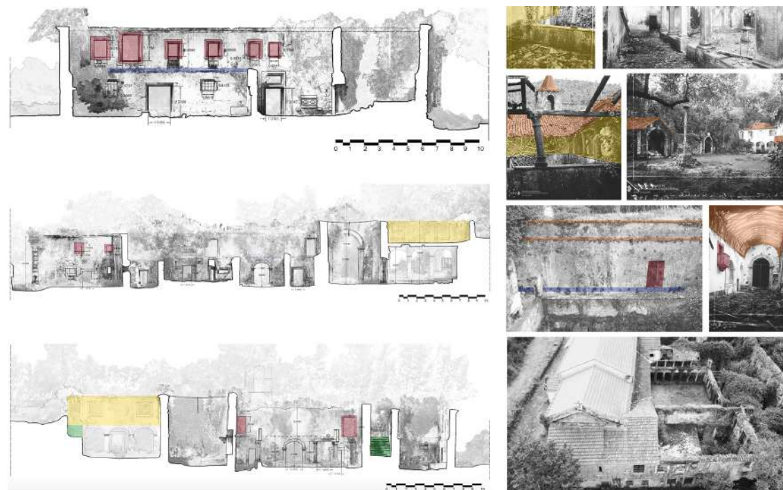
Fig. 6 - Analisi delle tracce per la lettura e l'interpretazione del complesso religioso, eseguita sulla base degli elaborati tecnici bidimensionali ottenuti dal rilievo digitale e coadiuvata dalle fotografie storiche.
