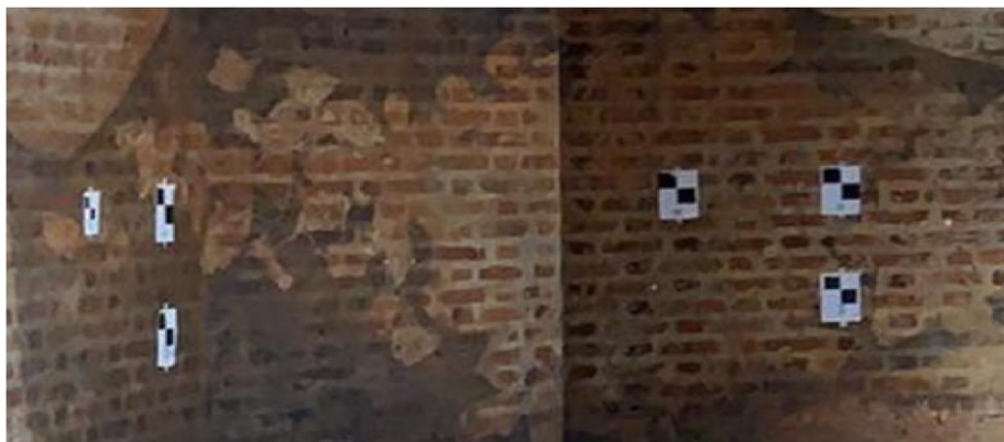
Fig. 7. Vista de dianas empleadas durante el levantamiento con Escáner láser terrestre. Imagen tomada del Proyecto “Que no baje el telón”
