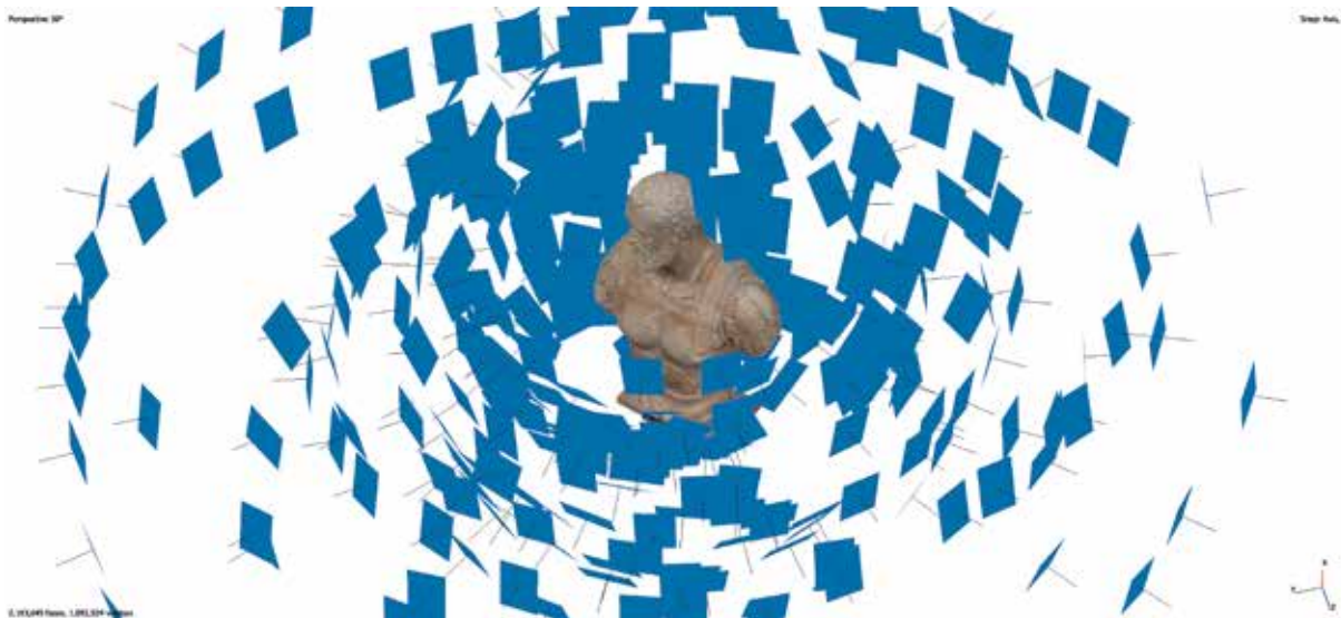
Figura 9. Screenshot del modello fotogrammetrico con visualizzazione della posizione della camera al momento dello scatto.
