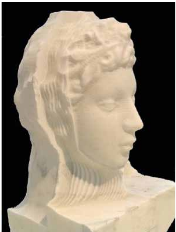
Figura 7A e 7B. Testa di un profeta (Opera del Duomo di Firenze). Differenti fasi di lavorazione con frese progressivamente più sottili.
