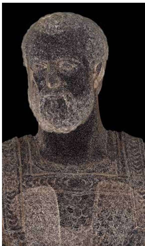
Figura 6. Modello di punti del busto di Cosimo ottenuto da un rilievo fotogrammetrico: la numerosità di punti che, a differenza della immagine precedente, descrive la forma con maggiore dettaglio consente la riproduzione automatica.
