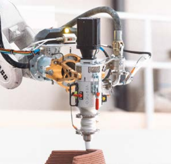
Fig. 4: Vertico 2K Printhead
