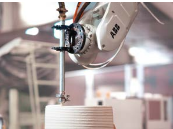
Fig. 2: Vertico 1K Printhead
