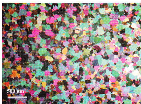
Immagini al microscopio ottico polarizzatore di una sezione ultrasottile (spessore 5\mu ) di marmo bianco P: (sz) ingrandimenti 6X, (dx) 25 X.
