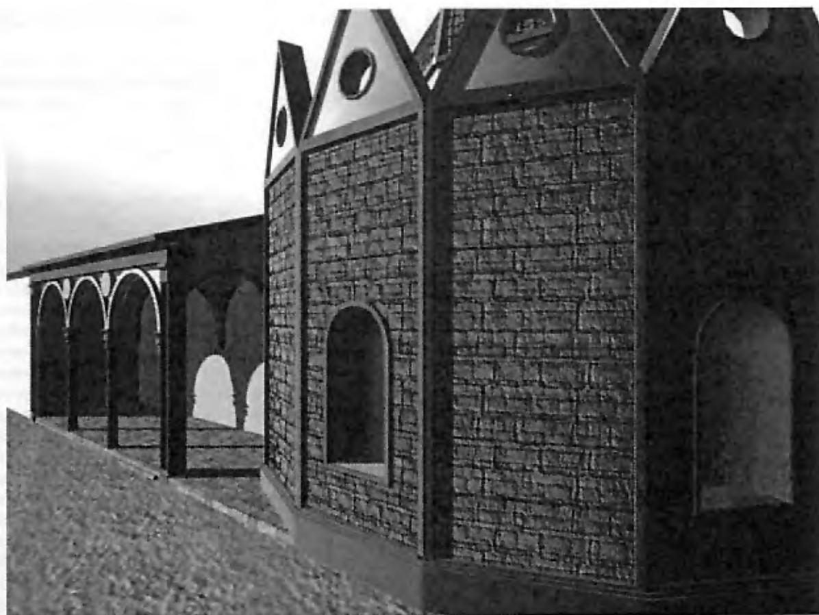
Figura 7. Ricostruzione in rendering della nostra ipotesi con il portico (a 3 campate) posto tra la Rotonda e il Convento con vista dal Campaccio verso via degli Agnoli.
