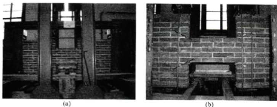
Figura 5. Set-up di prova DICeA: (a) telaio di contrasto (b) strumentazione
