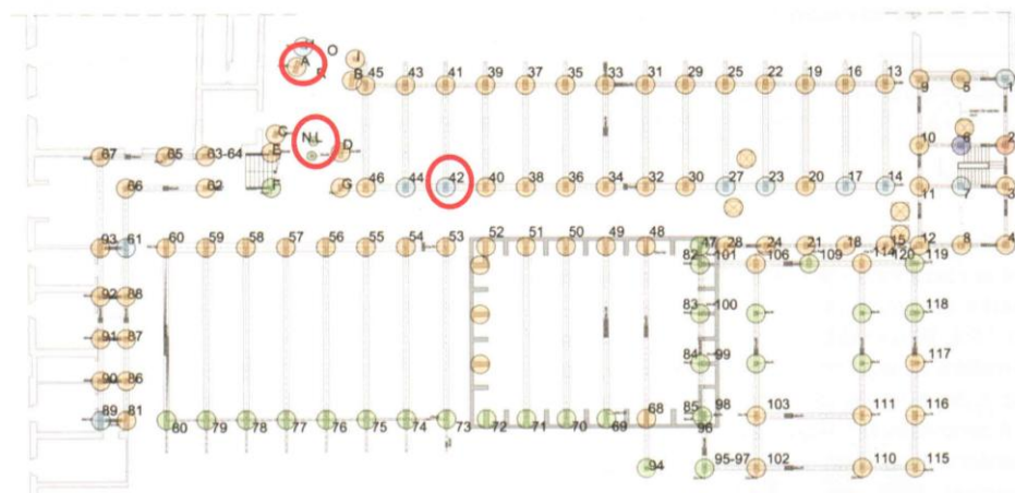
Figura 28 – Disposizione in pianta degli isolatori
