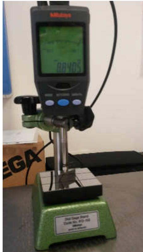
*Figura 19: misure sul blocchetto di spessore 1,5 mm con il comparatore digitale*
