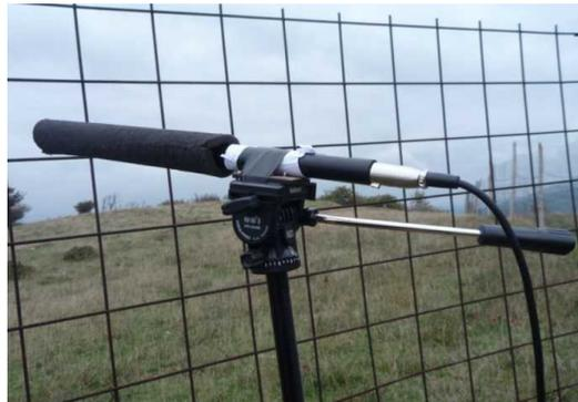
*Figura 16 - Microfono Sennheiser ME 67 utilizzato in postazione fissa (Foto C. Trunfio).*
