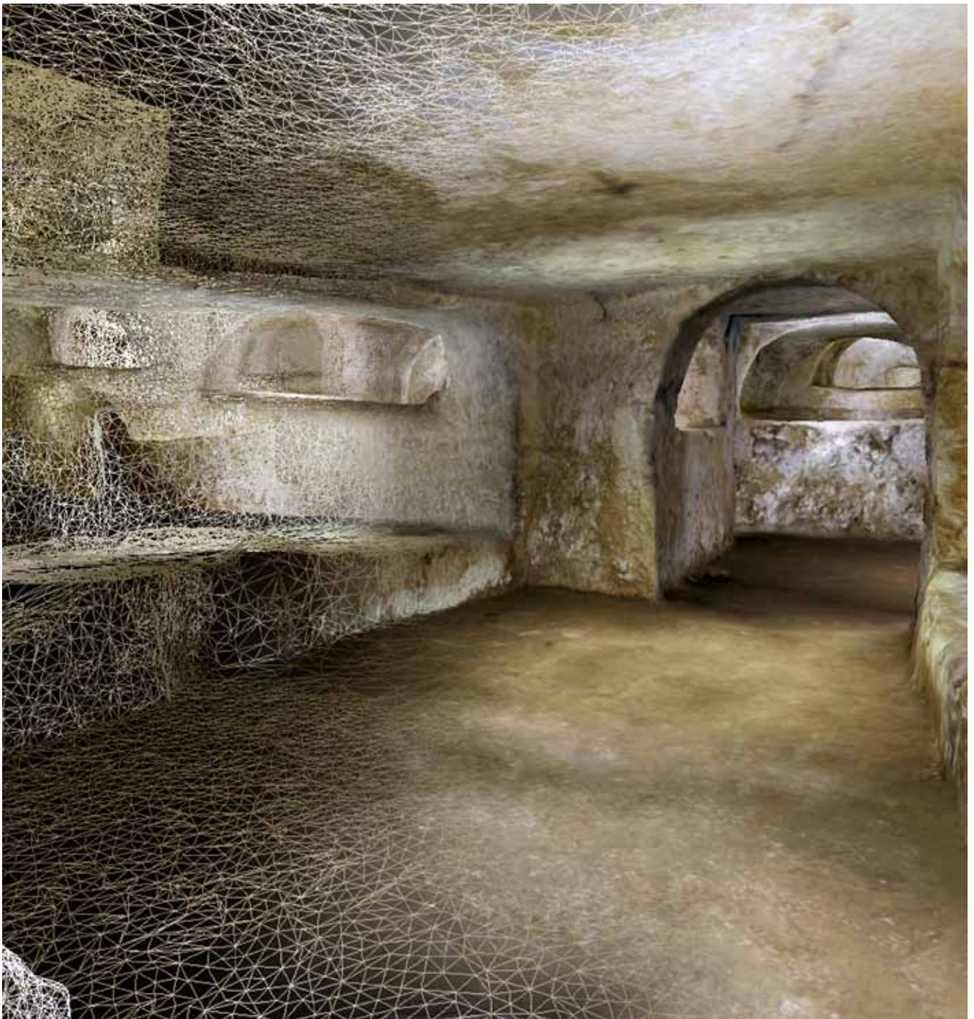
Elaborazione grafica di una vista del modello 3DIM. L'area centrale dell'ipogeo n.3 del complesso di St. Augustine a Rabat tra mesh poligonale e superficie texturizzata
