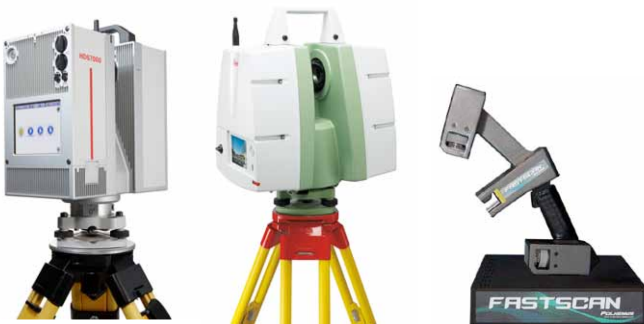
Le tre diverse tipologie di 3D Laser Scanner utilizzati nel corso delle operazioni di rilievo scelti in base alle caratteristiche dell'oggetto e al livello di dettaglio necessario
