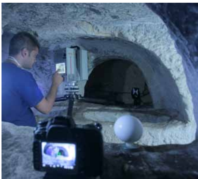
Utilizzo simultaneo di target sferici e piani durante rilievi di tipo laser scanner in ambiente ipogeo
