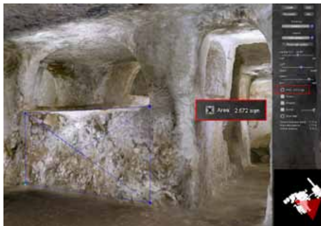
Misurazione dell'area di porzioni di superficie scelte attraverso la selezione dei punti di bordo
