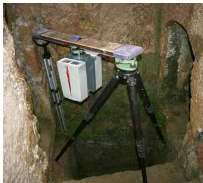
Sperimentazione di scansione laser a testa rovesciata per la misurazione di spazi concavi di difficile raggiungimento
