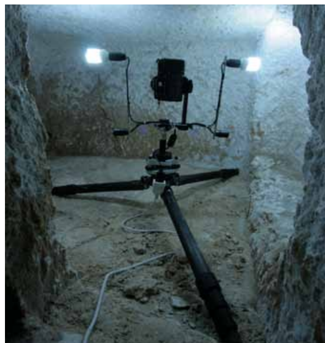
Il sistema di illuminazione "integrato" utilizzato durante il rilievo del complesso di St. Augustine
