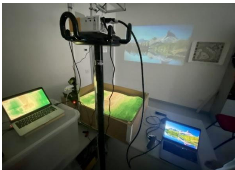
Fig. 2 - SandBox AR: prototipo realizzato artigianalmente
