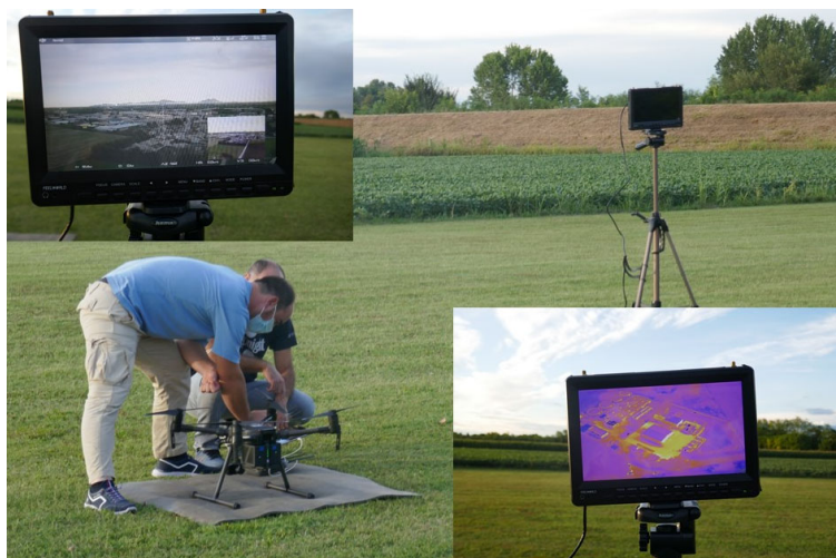
Fig. 1 - Preparazione del set di un rilievo con droni per facilitare l’esperienza della verticalità. Viene montato un schermo su treppiede che mostra quanto ripreso con il drone sia con sensore ottico che termico. Attività realizzata in collaborazione con Archetipo srl
