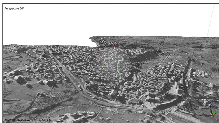
Fig. 2 - Modello 3D in ambiente Metashape, realizzato a partire da ortofotomosaici di foto aeree storiche della città di Viterbo
