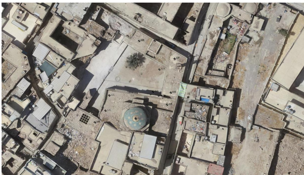
Figure 5. Veduta di una orthophoto ottenuta dall'elaborazione fotogrammetrica delle foto acquisite da UAV
