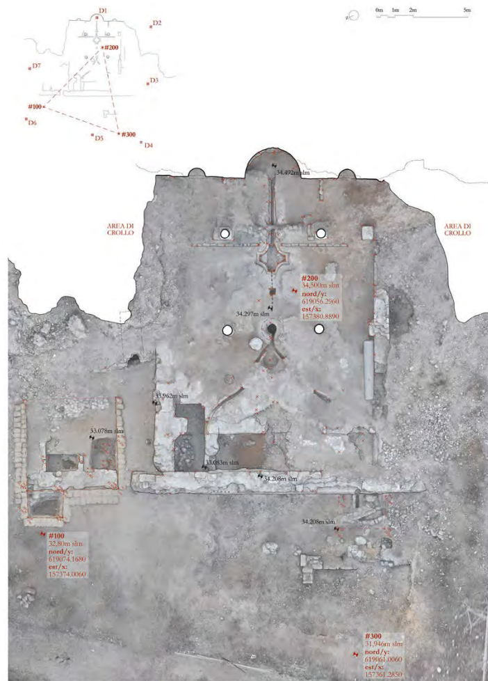
Fig. 9. Planimetria con indicazione delle tre stazioni topografiche e quote altimetriche GPS (© AskGate).
