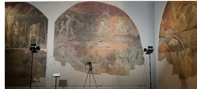
Fig. 3.5 set-up utilizzato per il rilievo fotogrammetrico Structure from Motion all'interno della sala del Museo.
