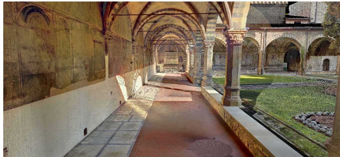
Fig. 2.4 vista prospettica da nuvola di punti laser scanner del lato Ovest del chiostro Verde in Santa Maria Novella.
