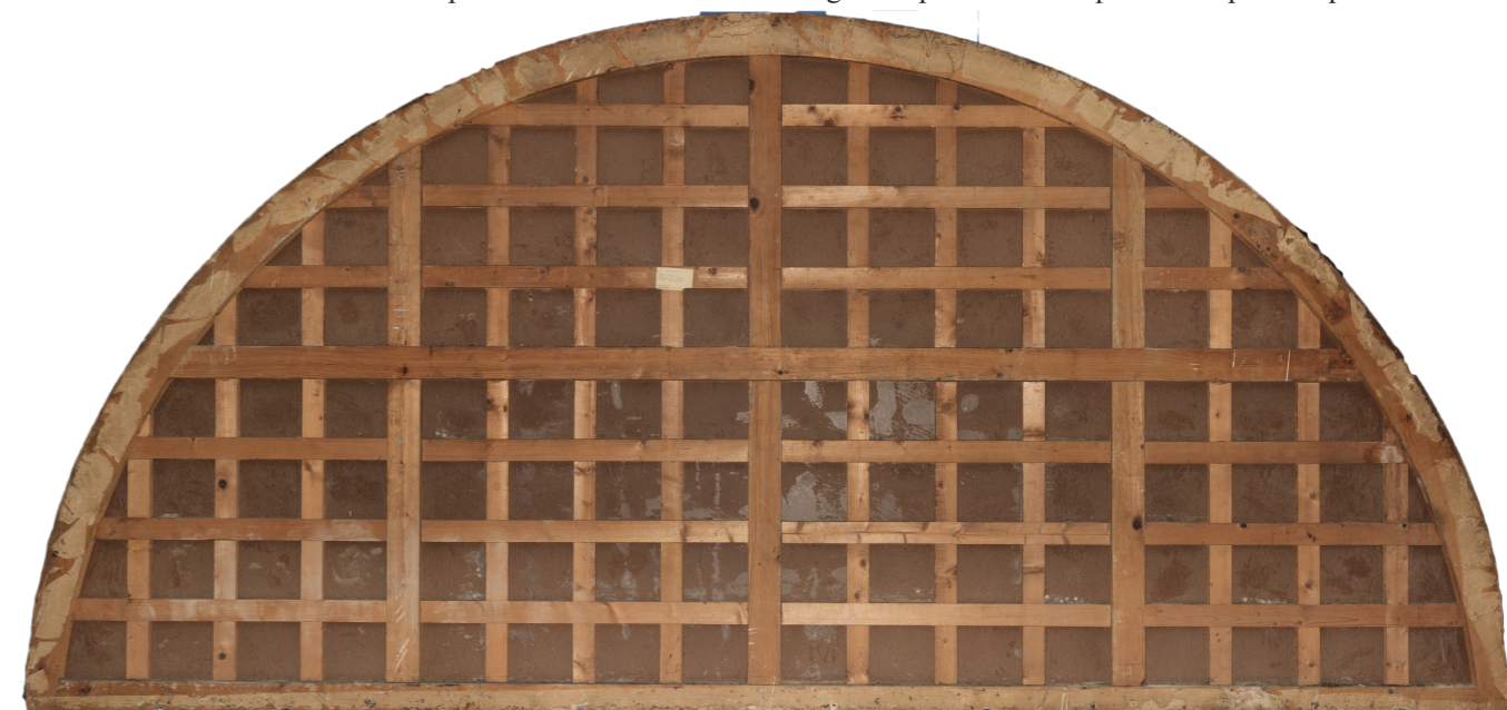
Fig. 2.10 supporto in masonite semi-tamburata utilizzata da Leonetto Tintori. In fotografia il supporto dell'affresco "La creazione degli animali e la creazione di Adamo", lato Est del chiostro Verde.
