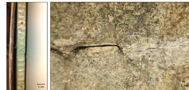
Fig.2.28 imbarcamenti e lesioni di recente formazione (si vedano i bordi bianchi della frattura, segno di recente perdita di colore) rilevati negli affreschi musealizzati.
