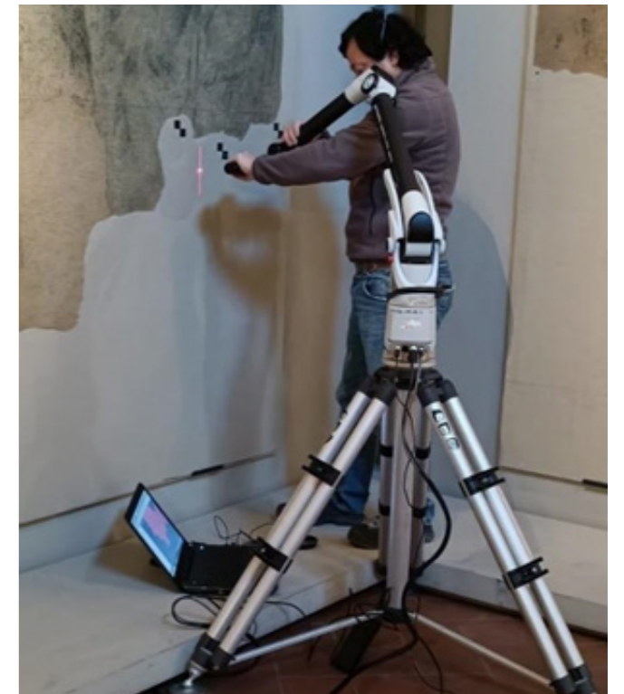
Fig. 3.7 fasi di rilievo con laser Romer Absolute Arm 7320SI. solamente nuvole di punti e non mesh . Nel caso della tecnica di triangolazione attiva, si hanno i seguenti vantaggi:
