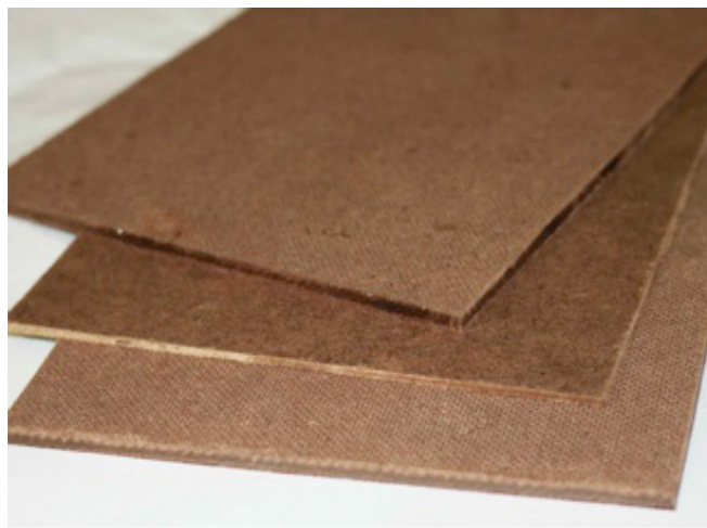
Fig. 1.9 pannelli di Masonite con formati standard.
