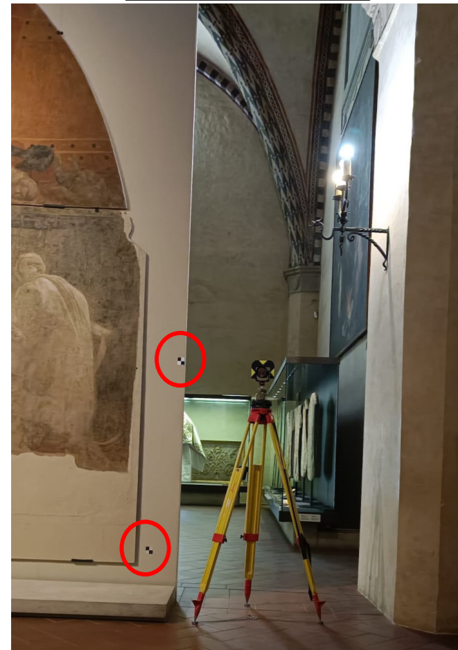
Fig. 3.12 localizzazione target presso sala museale SMN e geo-referenzazione tramite stazione totale.
