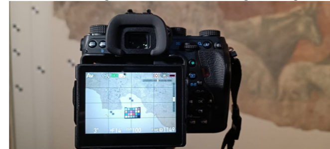
Fig. 3.5 set-up utilizzato per il rilievo fotogrammetrico Structure from Motion all'interno della sala del Museo.
