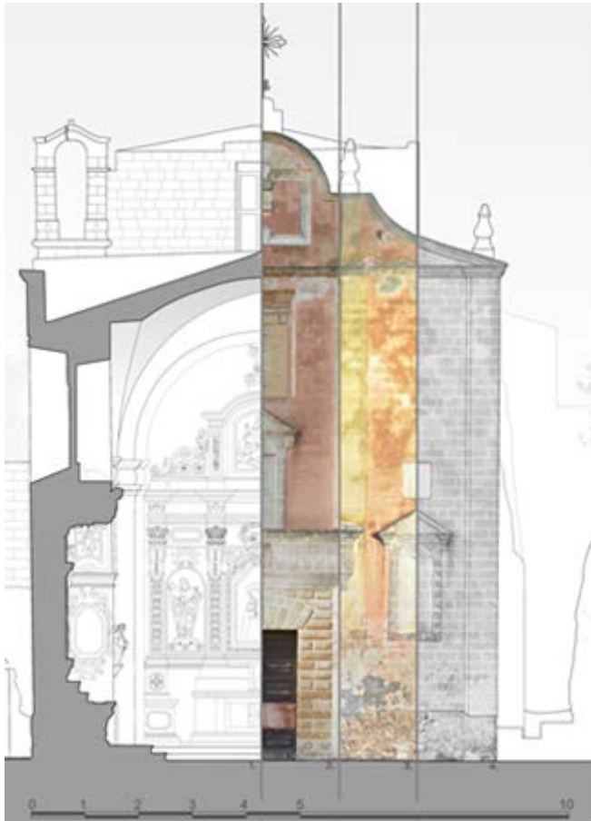
Figura 10: Madonna di Tutte le Grazie. Sintesi delle rappresentazioni grafiche: 1. Sezione interna in vettoriale; 2. raster fotogrammetrica; 3. raster da nuvola di punti Recap Pro; 4. elaborazione con integrazione raster e vettoriale.
