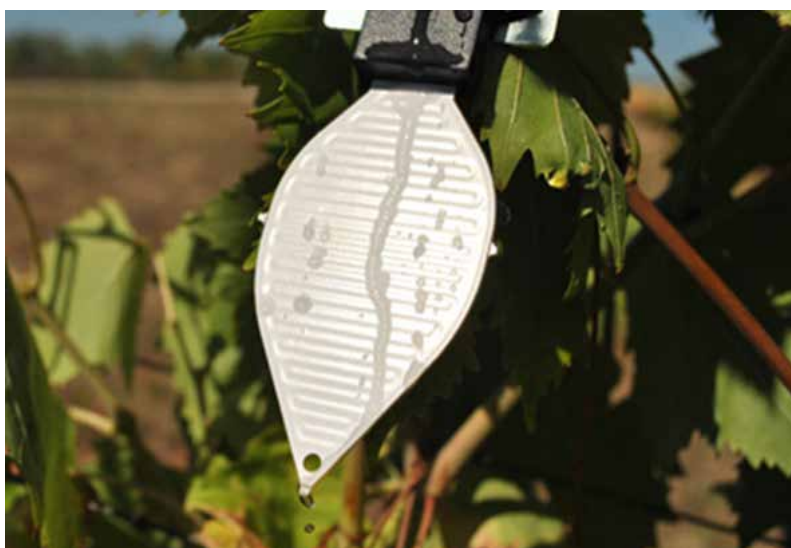
Figura 6.15. Sensore di bagnatura fogliare (fonte: per gentile concessione della ditta Netsens S.r.l.)
