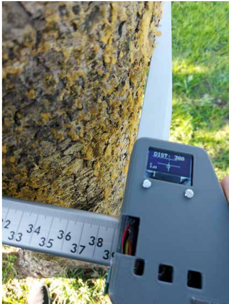
Figura 5.3. Particolare del cavalletto elettronico open-source sviluppato dal CREA (foto: Corrado Costa)
