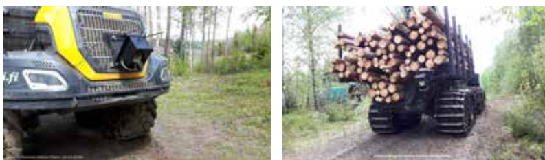
Figura 8.27. Sensori laser applicati nella parte anteriore di un harvester (per rilevare il profilo del suolo prima del passaggio del mezzo) e posteriore di un forwarder (per rilevare il profilo del suolo subito dopo il passaggio) (fonte: © Luke/Jari Ala-Ilomäki)
