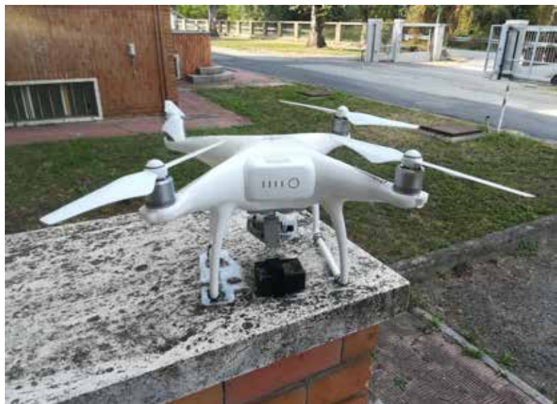
Figura 6.12. Aereomobile a pilotaggio remoto (drone) con sensore per rilevare l'indice NDVI (foto: Pier Mario Chiarabaglio)
