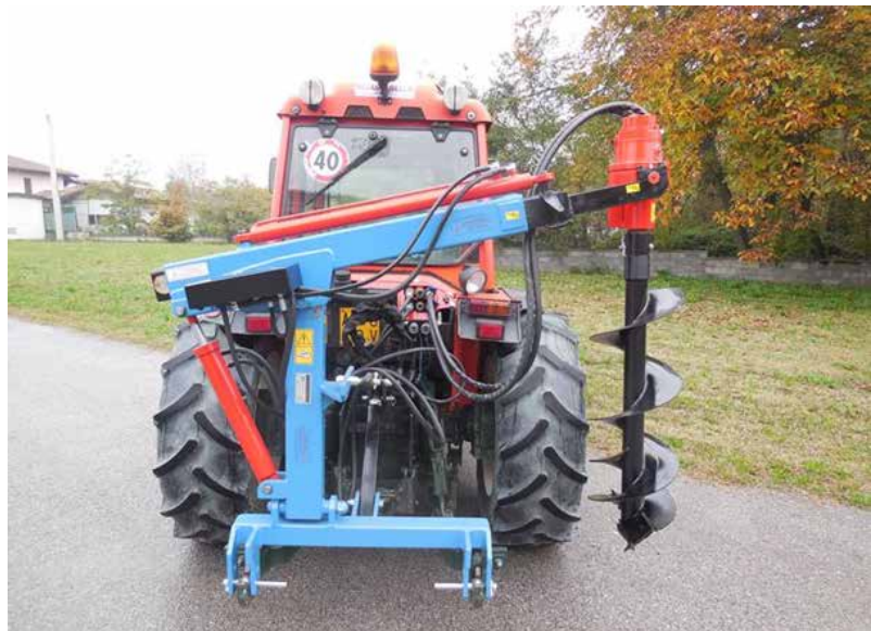
Figura 6.3. Trivella portata da trattore con dispositivo per il posizionamento satellitare (foto: Pier Mario Chiarabaglio)
