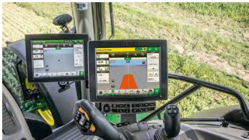
Figura 6.4. Dispositivo di supporto alla guida della trattore per il corretto posizionamento della trivella per l'apertura buche (fonte: per gentile concessione della ditta Conterno & Ocelli s.r.l.)
