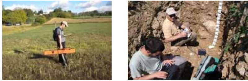
Figura 6.1. Strumenti proximal sensing : a sinistra, strumento per indagine elettromagnetica dei suoli EM38 (fonte: CREA - https://soilmaps.wordpress.com/dscn0490/ ); a destra, spettroradiometro da laboratorio e da campo ASD Fieldspec; il rilevamento nell'immagine di destra rientra nel campo del digital soil morphometrics continuo delle proprietà dei diversi orizzonti di suolo (foto: Roberto Barbetti)
