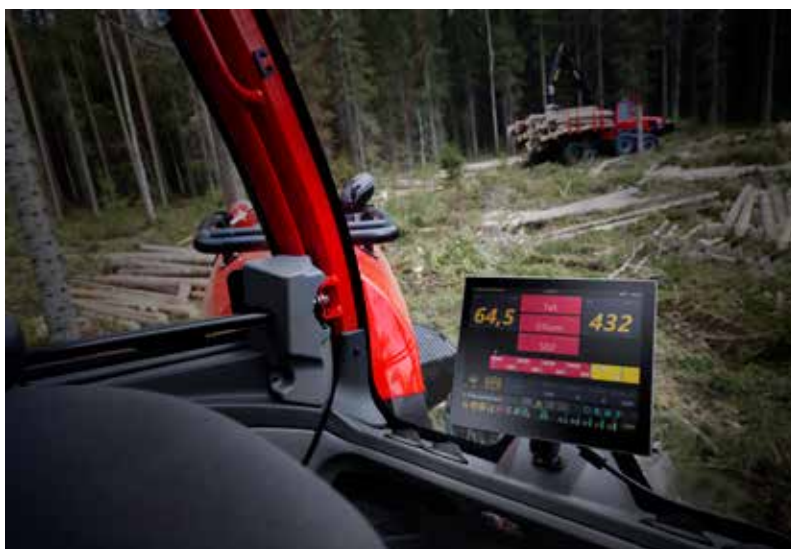
Figura 8.8. Schermata display di una macchina operatrice combinata per la visualizzazione in tempo reale di informazioni raccolte dai sensori installati (fonte: https://www.komatsuforest.co.uk/forest-machines )
