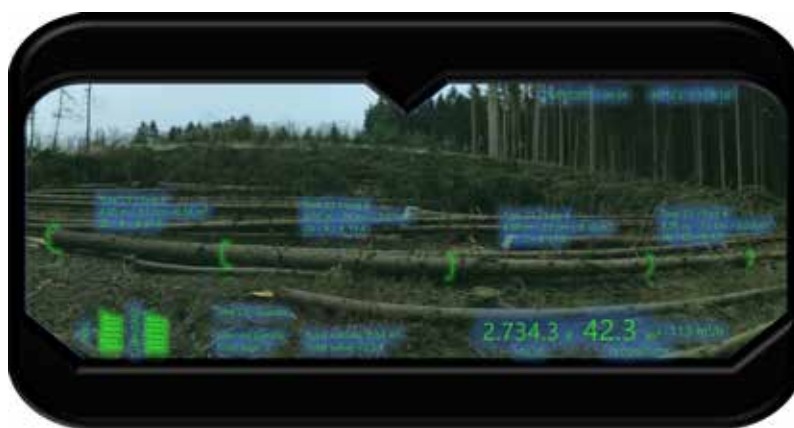
Figura 8.19. T4E Bucking App per individuare le misure ottimali degli assortimenti in relazione alla morfologia del fusto ed alla presenza di difetti. I dettagli dimensionali, qualitativi ed economici di ogni sezione di fusto sono riportati nella schermata (fonte: T4E Bucking App )
