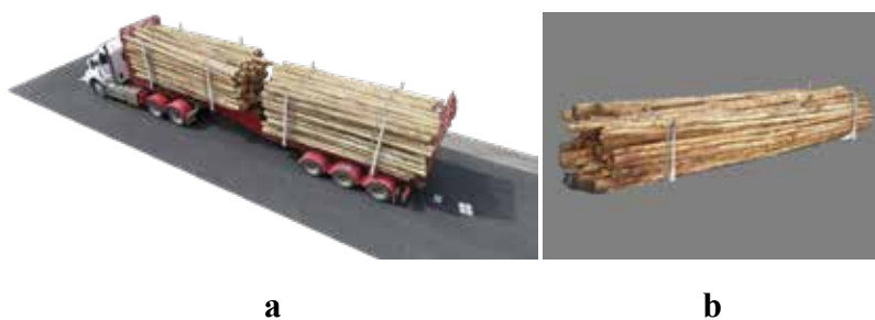
Figura 10.4. (a) Stima automatica del volume di legname tramite fotogrammetria su pianale di carico di un mezzo adibito al trasporto; (b) ricostruzione 3D del carico ottenuta partendo da immagini scattate da drone (fonte: Acuna e Sosa 2019)
