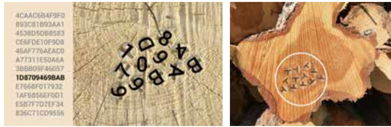
Figura 9.2. Marcatura con codice a incisione nella fibra legnosa (fonte: Otmetka)
