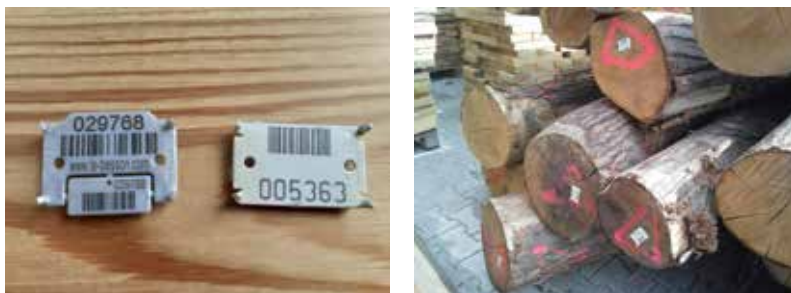
Figura 9.1. Etichette plastiche professionali “plaquette” con codice a barre e alfanumerico utilizzate per la marcatura dei singoli tronchi (immagini: Gianni Picchi)
