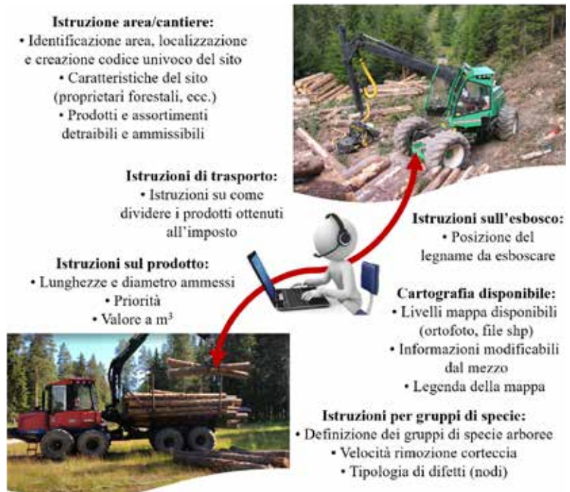
Figura 8.5. Rappresentazione schematica delle possibili comunicazioni tra macchine combinate e responsabile dei cantieri (immagine: Elena Marra)
