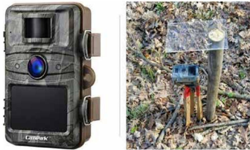
Figura 4.10. Fototrappola per la quantificazione della chioma (foto: Chianucci et al. 2021a)
