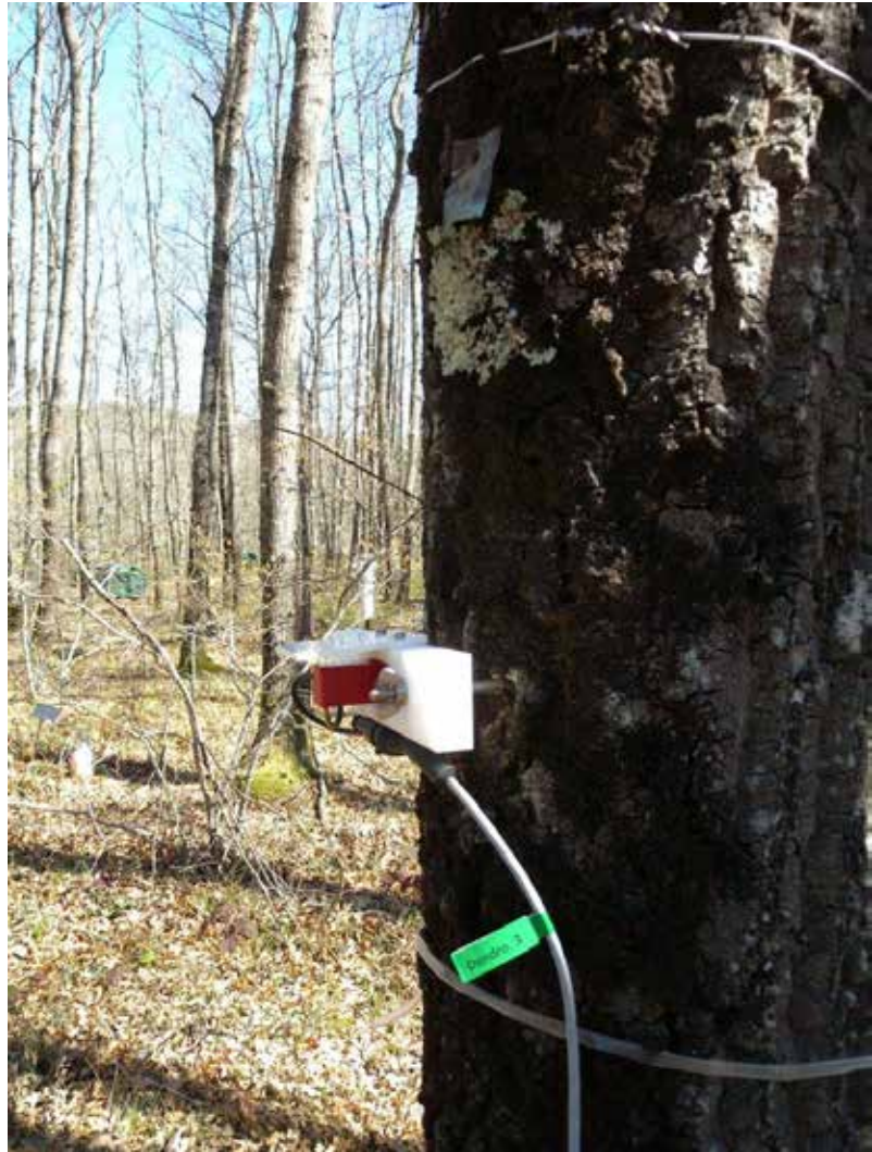
Figura 4.1. Dendrometro per il monitoraggio in continuo dell'attività cambiale (foto: Elena Paoletti)
