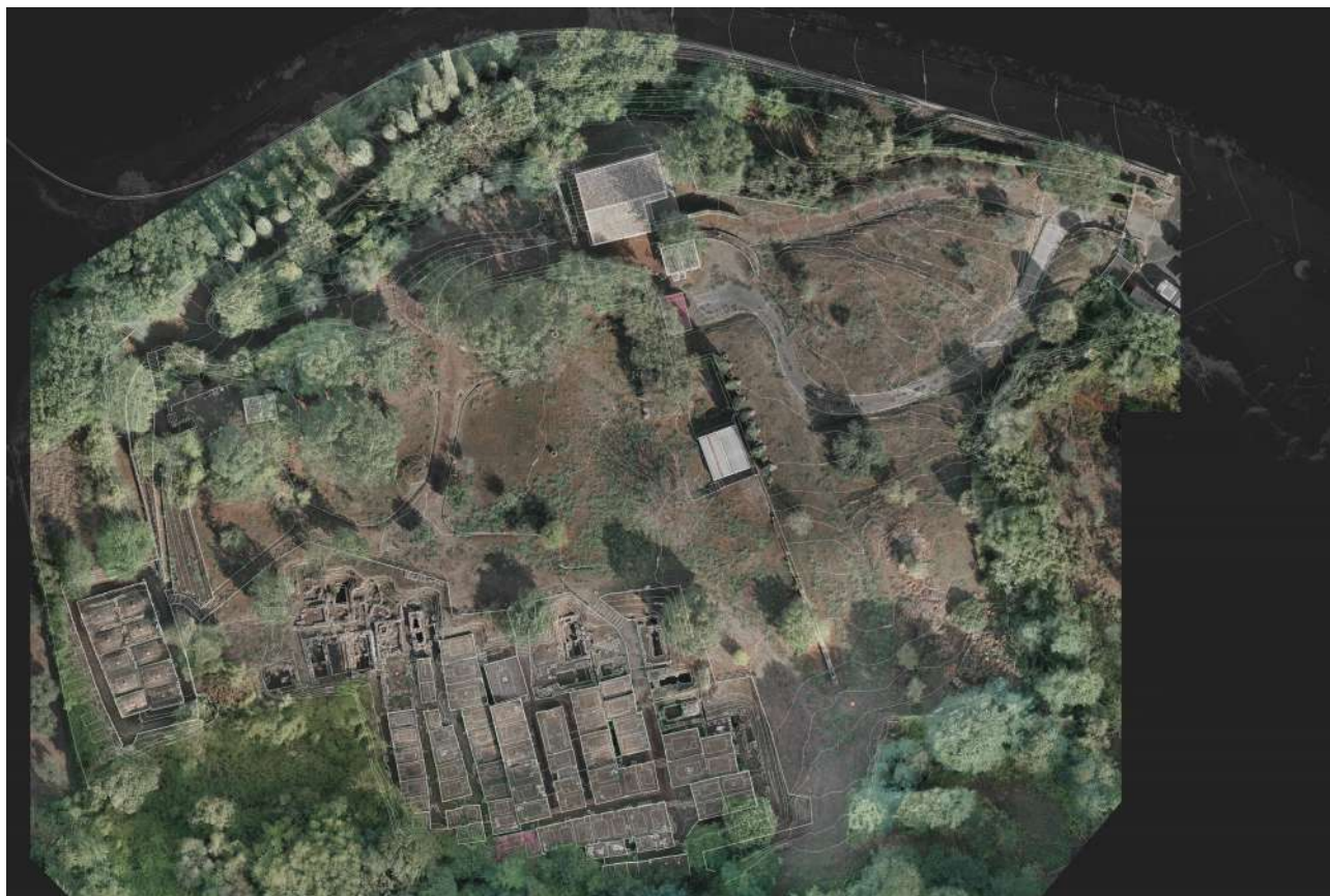
Fig. 6: Lo stato attuale dell'area archeologica della necropoli di Crocifisso del Tufo tramite una planimetria esportata dalla nuvola dei punti acquisita alla quale si sono sovrapposte l'ortofoto e la pianta delle coperture con il disegno delle curve di livello. Elaborato di Alessandro Nocentini.
