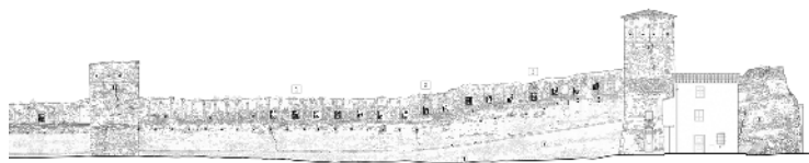
Fig. 5 - Lastra a Signa, tratto delle mura, con evidenziati (in nero) gli originari merli di coronamento (Enrico Deiana 2008).
