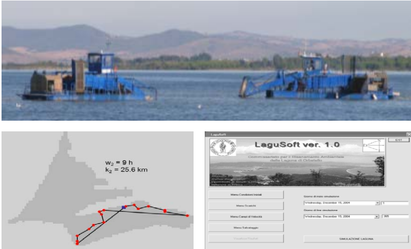
Figura 61 – La piattaforma software LaguSoft: (sinistra) percorso ottimale di un battello raccogli alghe calcolato da LaguSoft in base alle proiezioni di crescita della vegetazione sommersa; (destra) interfaccia utente di LaguSoft.
