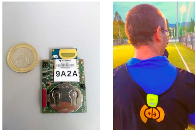
Figura 42 – (a sinistra) Struttura hardware del tag. (a destra) Il tag indossato sulla parte superiore della schiena del giocatore (racchiuso in un piccolo case giallo).
