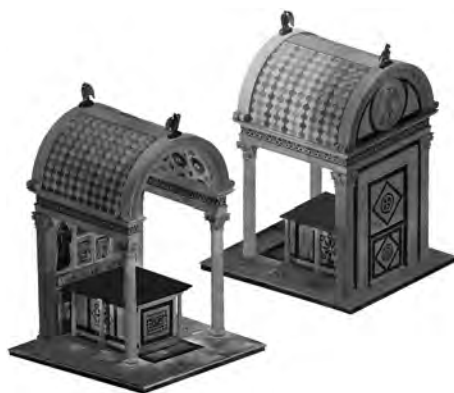
Fig.3: Il risultato dell'elaborazione fotogrammetrica della Cappella del Crocifisso (Ciborio).
