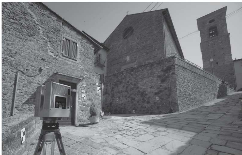
Figura 3. Laser-scanner Z+F Imager 5006h e target a centro di massa
