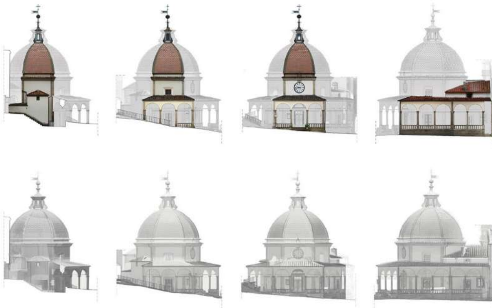
Figura 4. Restituzione a fotopiano, sovrapposizione tra la restituzione a filo di ferro e la nuvola di punti dell'Oratorio della Madonna del Morbo
