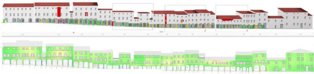
Figura 6. Analisi delle deformazioni mediante l'utilizzo delle elevation maps e modello schematico dei dissesti
