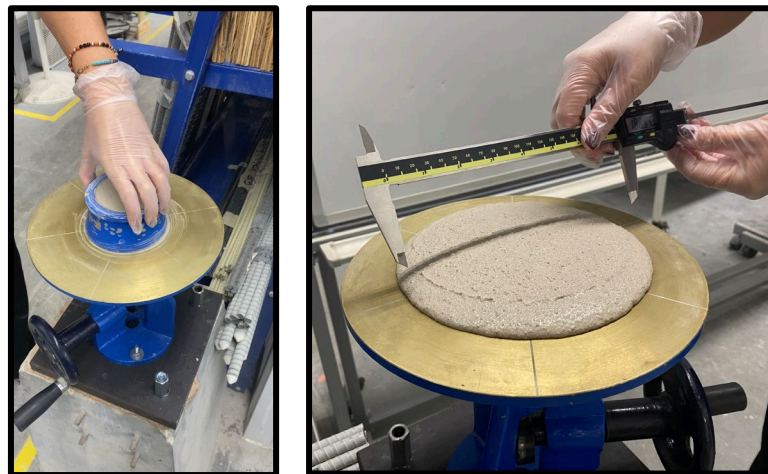
Fig. 10.3 Esecuzione del flow test per una delle miscele analizzate.
