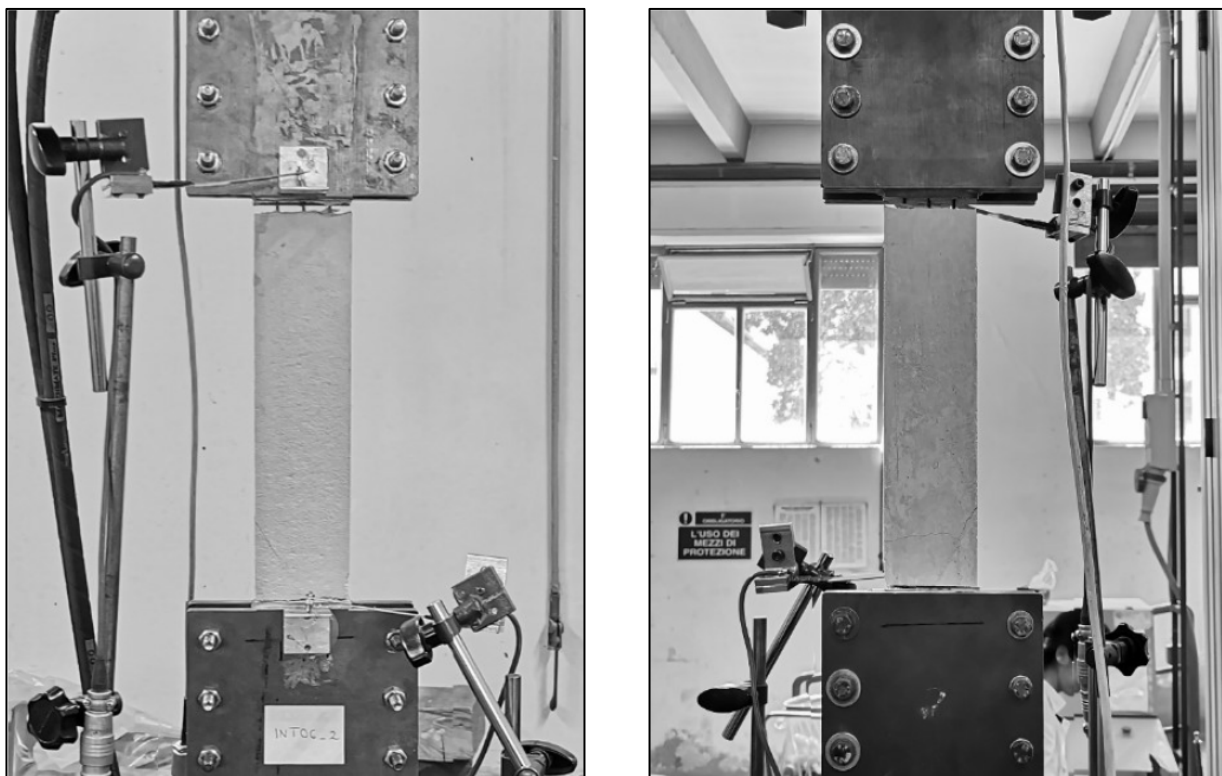
Fig. 3.22 Tipologia di rottura del coupon INT.06-C2.
