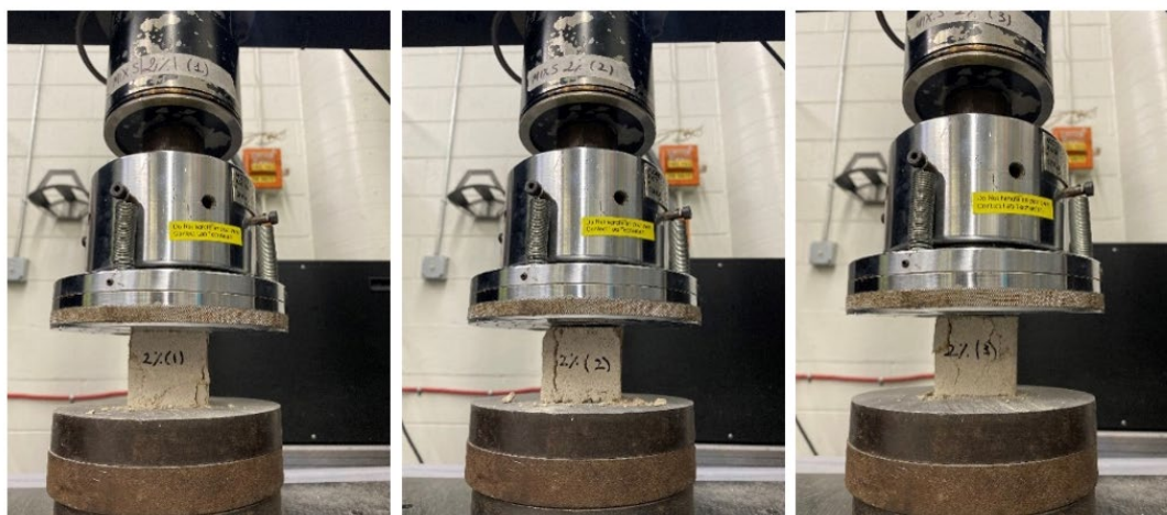
Fig. 12.11 Campioni di Mix.5 sottoposti a test di compressione.
