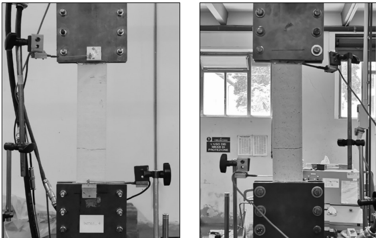
Fig. 3.10 Tipologia di rottura del coupon INT.01-C4.
