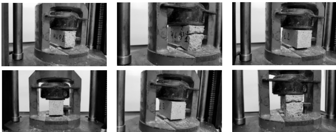
Fig. 2.55 Campioni INT.03 C.1a-b, C.2a-b e C.3a-b. al termine del test.
