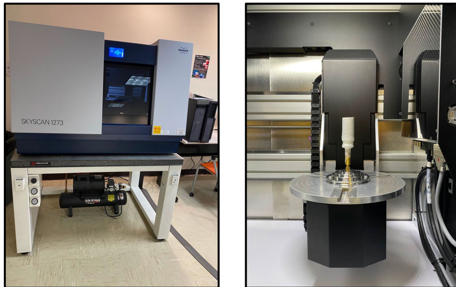
Fig. 9.2 Macchinario di prova micro-CT e posizionamento del campione di prova.
