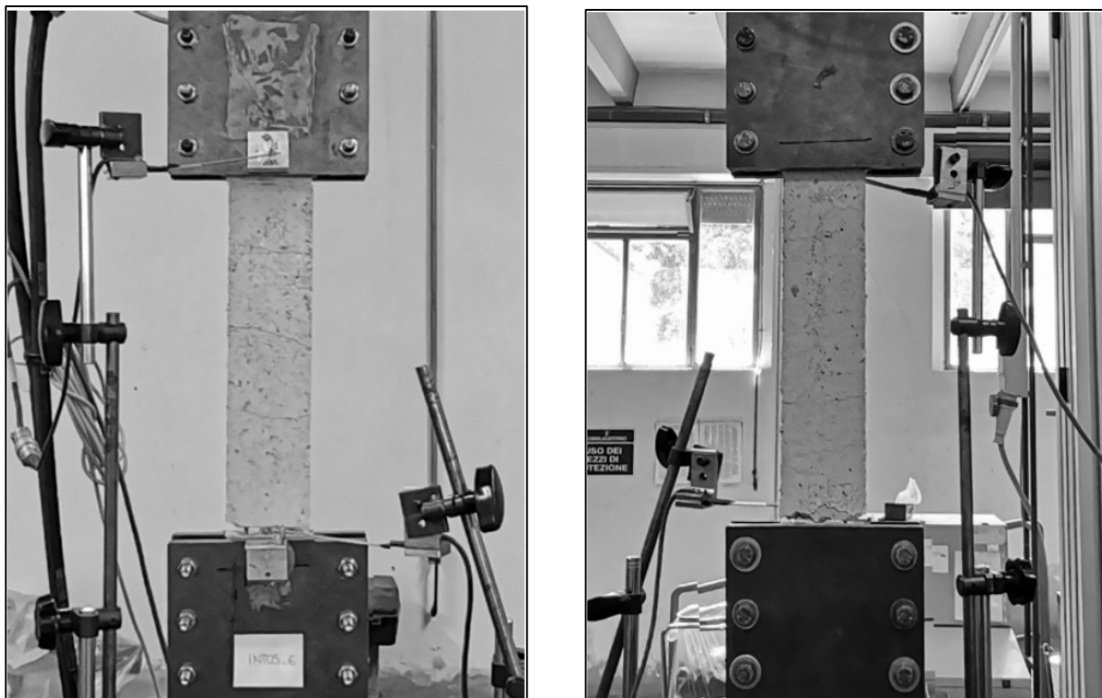
Fig. 3.19 Tipologia di rottura del coupon INT.05-C6.
