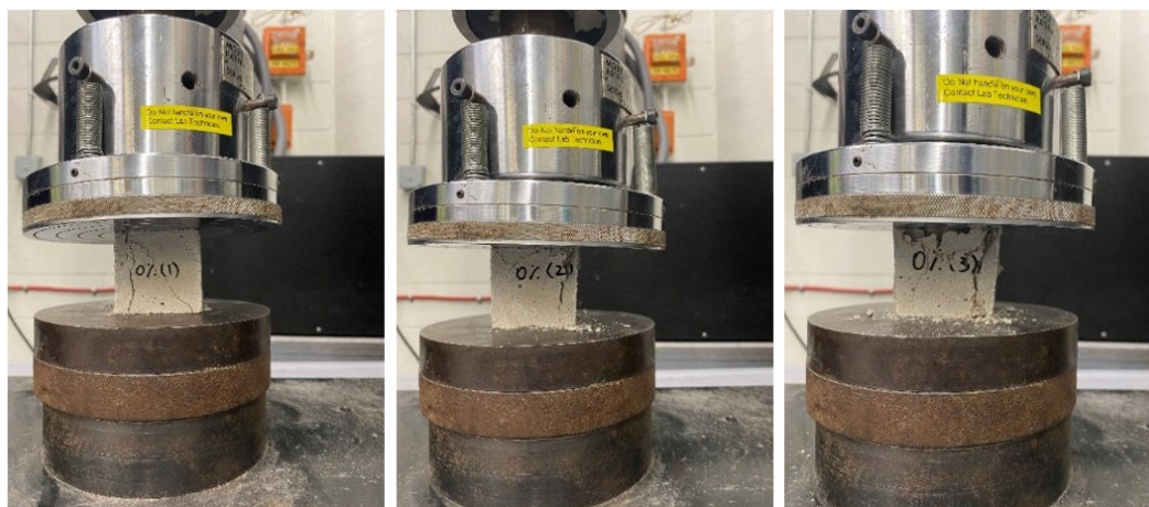
Fig. 12.3 Campioni di Mix.01 sottoposti a test di compressione.
