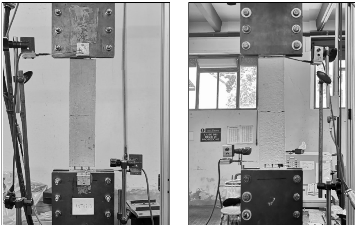
Fig. 3.23 Tipologia di rottura del coupon INT.06-C3.
