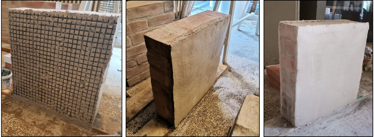
Fig. 5.2 Fasi di applicazione del rinforzo su una e su entrambi le superfici.
