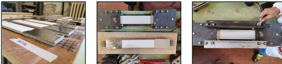
Fig. 3.2 Applicazione delle tabs e ancoraggio dei coupon alle piastre metalliche.
