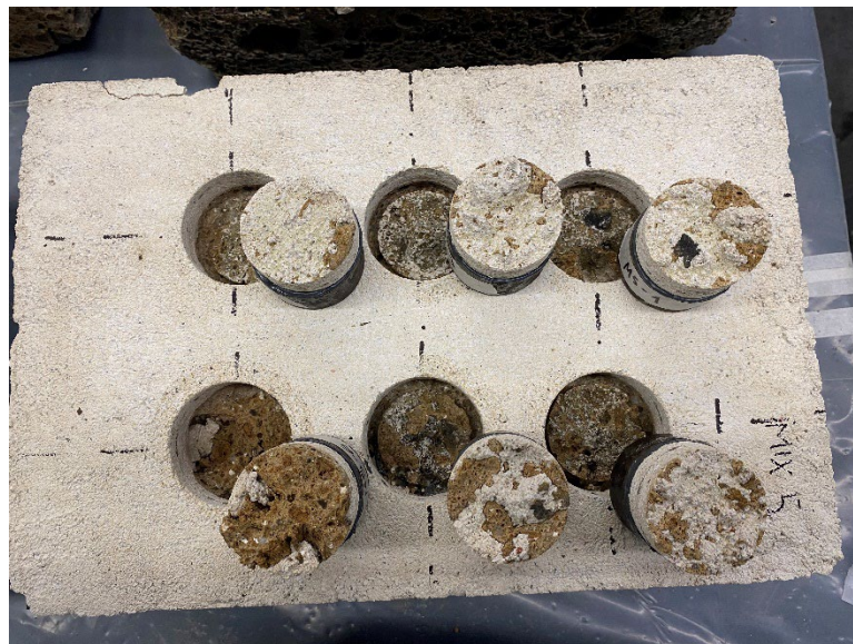
Fig. 13.30 Campioni di Mix.5-T sottoposti a test di adesione pull-off.
