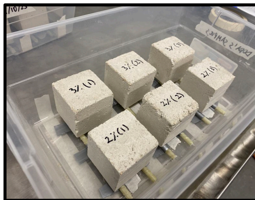
Fig. 11.5 Set up di prova preparato per la valutazione dell'assorbimento di acqua capillare.
