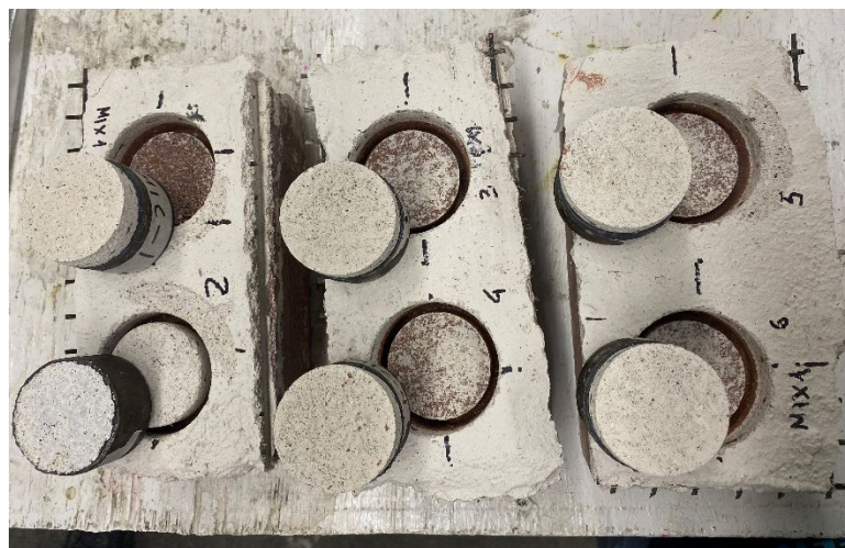
Fig. 13.10 Campioni di Mix.1- L sottoposti a test di adesione pull-off.
