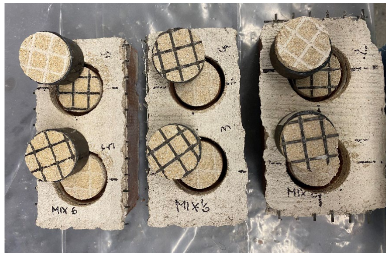
Fig. 13.20 Campioni di Mix.6- L sottoposti a test di adesione pull-off.
