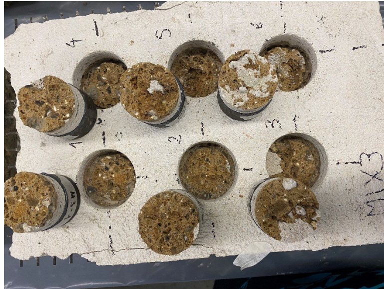
Fig. 13.26 Campioni di Mix.3- T sottoposti a test di adesione pull-off.
