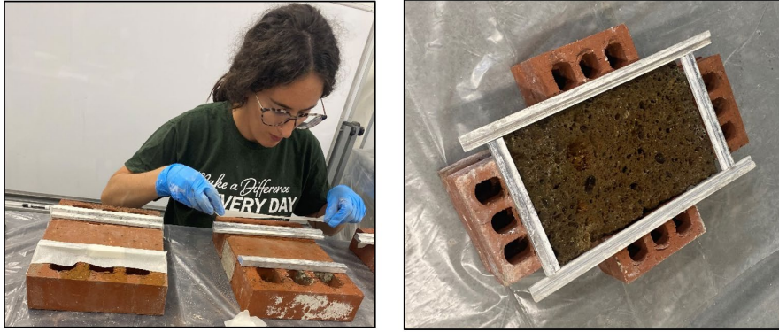
Fig. 13.3 Preparazione delle casseforme sui mattoni in laterizio e in tufo.
