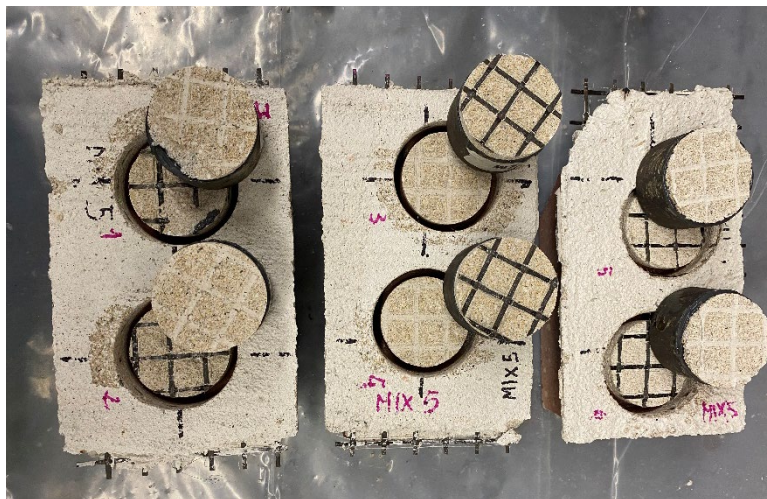
Fig. 13.18 Campioni di Mix.5- L sottoposti a test di adesione pull-off.
