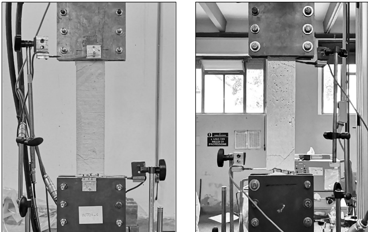
Fig. 3.12 Tipologia di rottura del coupon INT.01-C6.
