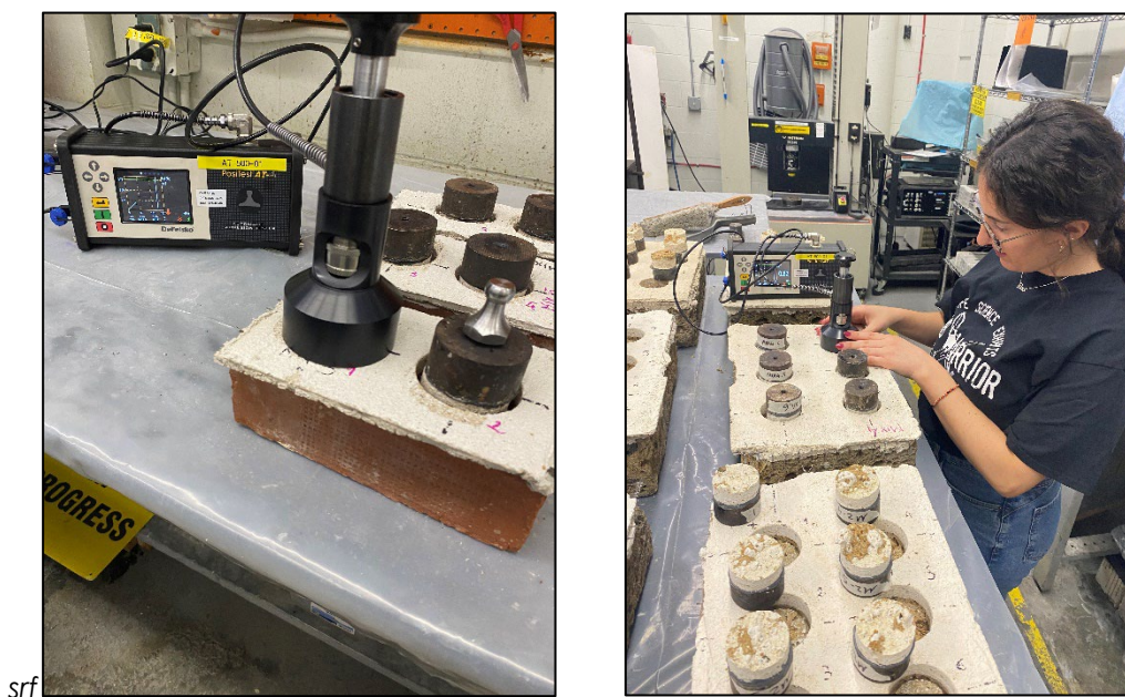
Fig. 13.8 Tester portatile di adesione a strappo utilizzato per le prove di pull-off [102].
