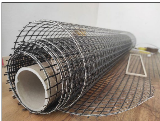
Fig. 2.73 Rete in fibra di basalto utilizzata per il rinforzo del nuovo composito FRLM.
