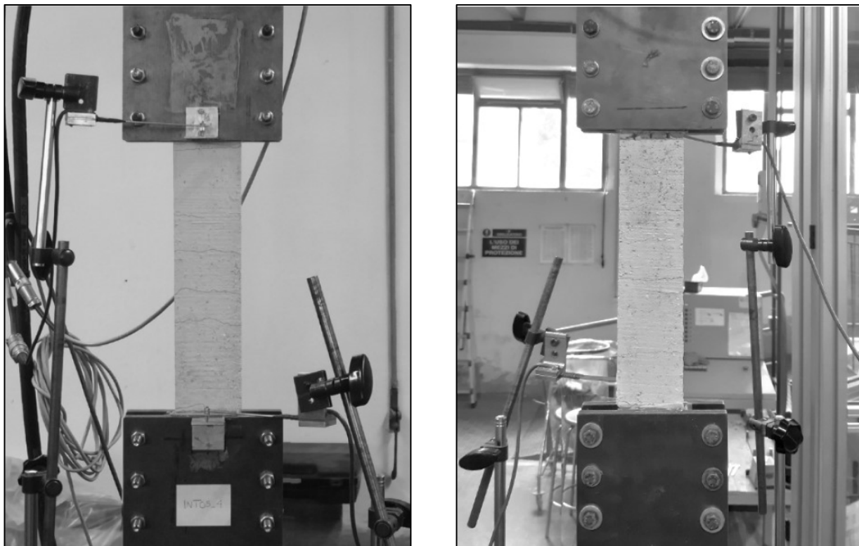
Fig. 3.17 Tipologia di rottura del coupon INT.05-C4.
