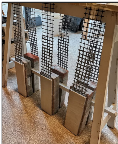
Fig. 4.30 Campioni dopo la stesura della resina epossidica e l'applicazione delle tabs in alluminio.
