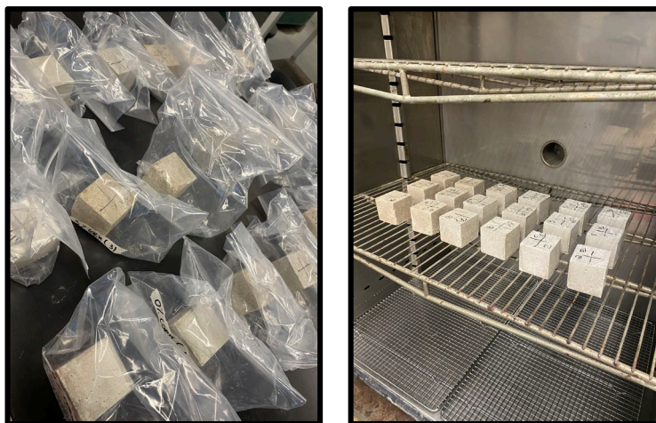
Fig. 11.2 Procedimento di maturazione dei provini e asciugatura in forno ventilato.
