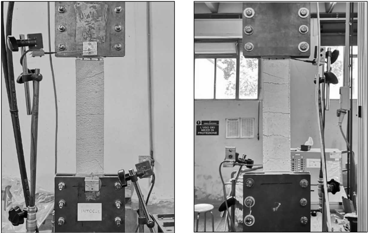
Fig. 3.21 Tipologia di rottura del coupon INT.06-C1.
