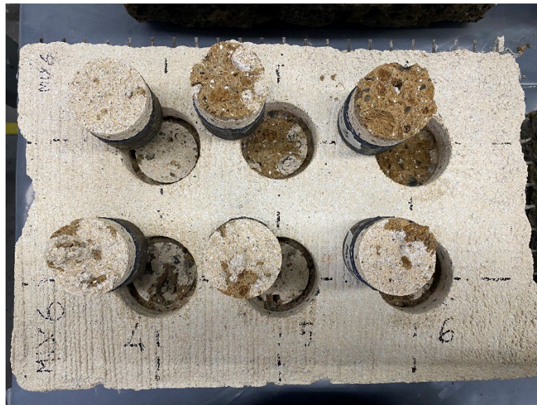
Fig. 13.32 Campioni di Mix.6-T sottoposti a test di adesione pull-off.
