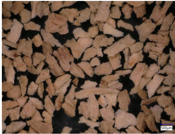
Fig. 9.4 Vista al microscopio con ingrandimento 50x dei granuli in sughero.
