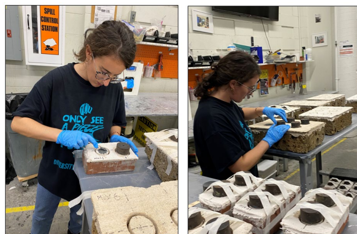
Fig. 13.7 Applicazione dell'adesivo epossidico bio-componente sui campioni.
