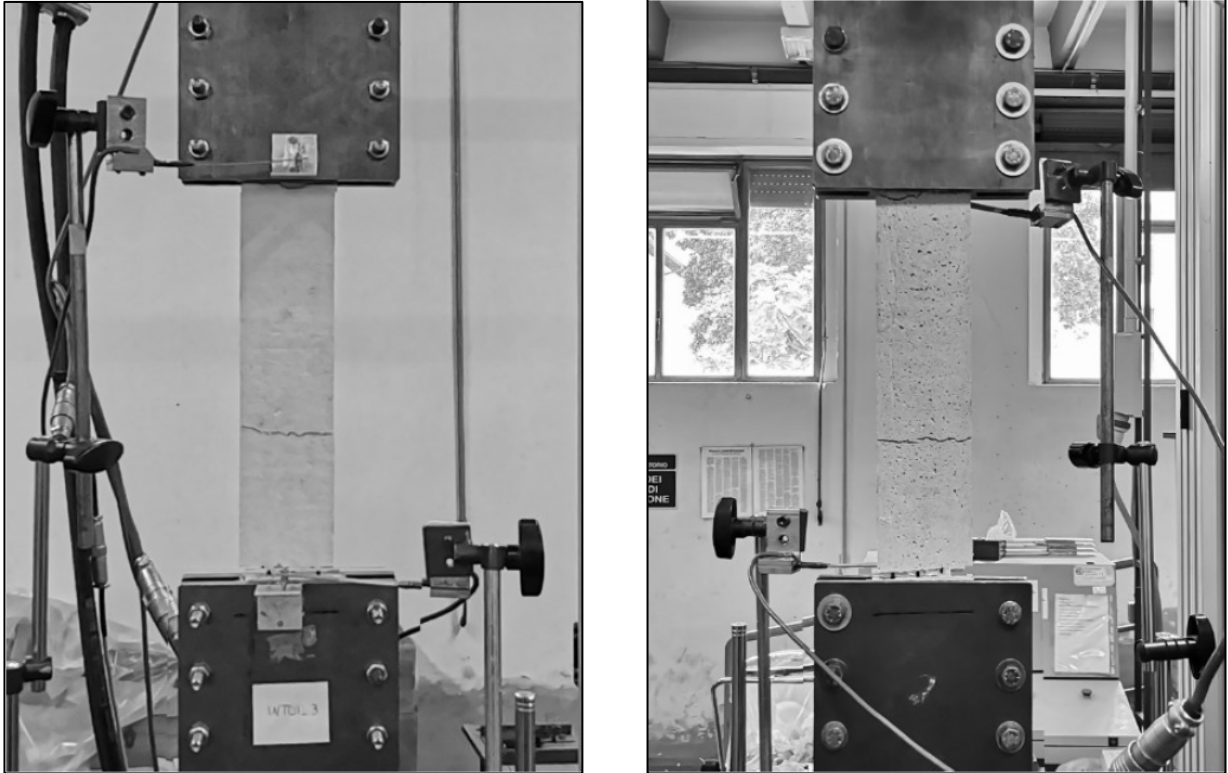
Fig. 3.9 Tipologia di rottura del coupon INT.01-C3.
