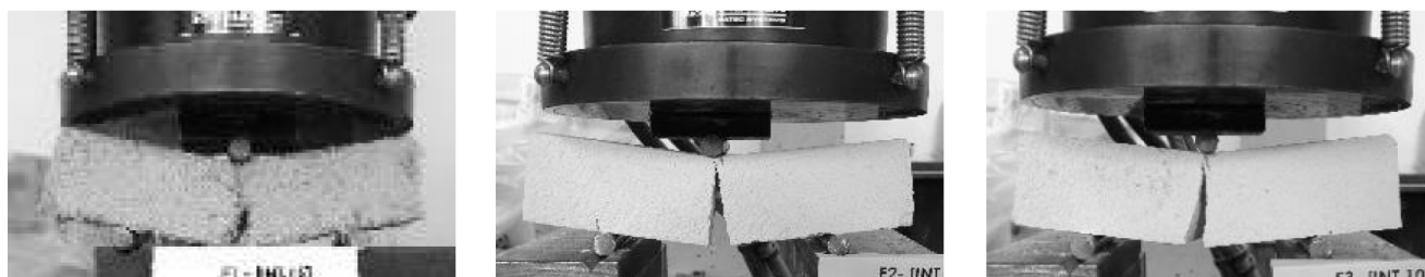
Fig. 2.40 Campioni INT.07-F.1, INT.07-F.2 e INT.07-F. al termine del test
