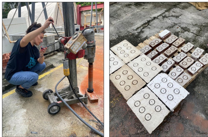
Fig. 13.6 Fase di taglio dei mattoni in laterizio e in tufo mediante carotatrice con bordo in corona diamantata.
