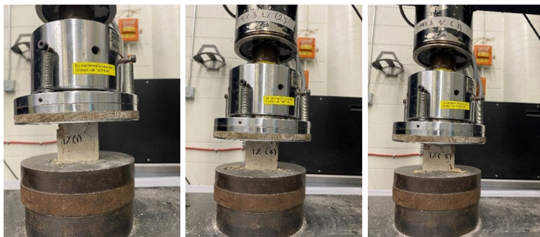
Fig. 12.7 Campioni di Mix.3 sottoposti a test di compressione.
