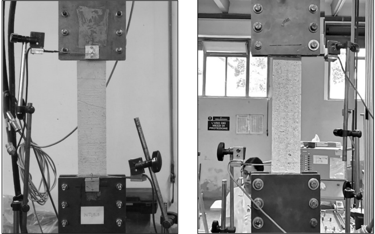
Fig. 3.18 Tipologia di rottura del coupon INT.05-C5.
