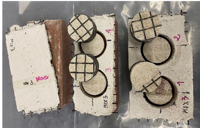
Fig. 13.14 Campioni di Mix.3- L sottoposti a test di adesione pull-off.
