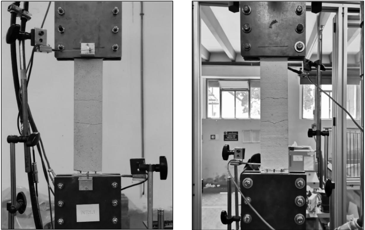
Fig. 3.7 Tipologia di rottura del coupon INT.01-C1.
