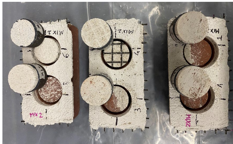
Fig. 13.12 Campioni di Mix.2- L sottoposti a test di adesione pull-off.
