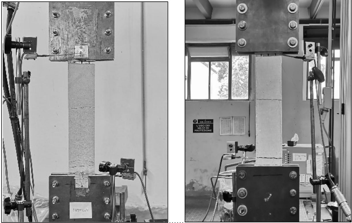
Fig. 3.25 Tipologia di rottura del coupon INT.06-C5.
