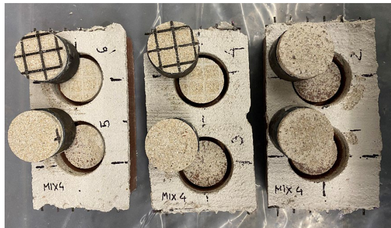
Fig. 13.16 Campioni di Mix.4- L sottoposti a test di adesione pull-off.
