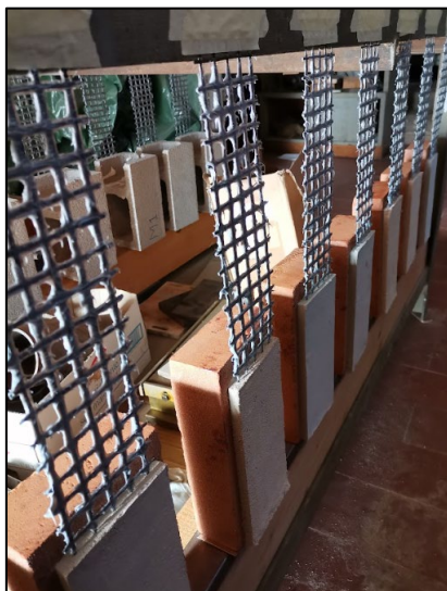
Fig. 4.3 Configurazione dei provini dopo la stesura della resina (a sinistra) e l'applicazione delle tabs metalliche (a destra).
