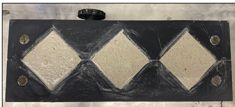
Fig. 11.1 Casseforme utilizzate per la preparazione dei campioni.
