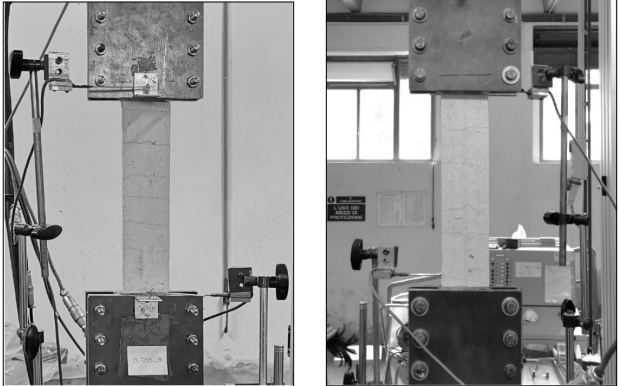
Fig. 3.16 Tipologia di rottura del coupon INT.05-C3.
