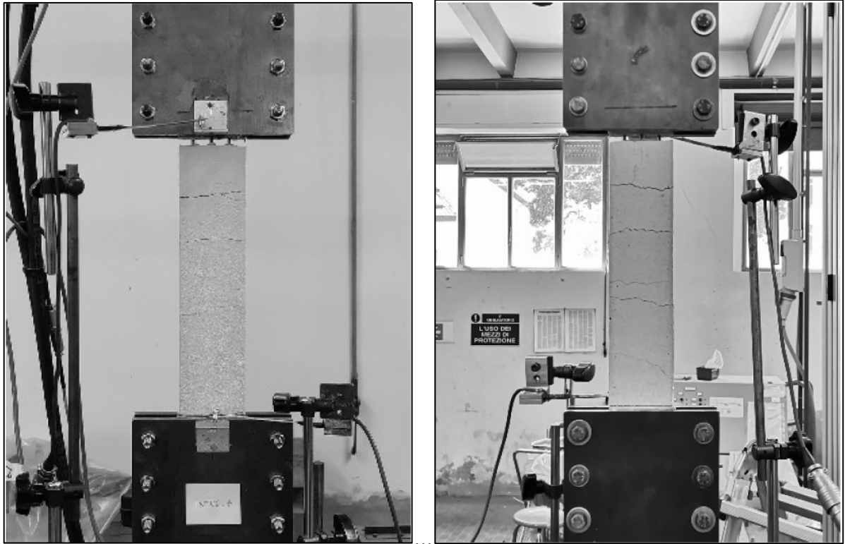
Fig. 3.24 Tipologia di rottura del coupon INT.06-C4.
