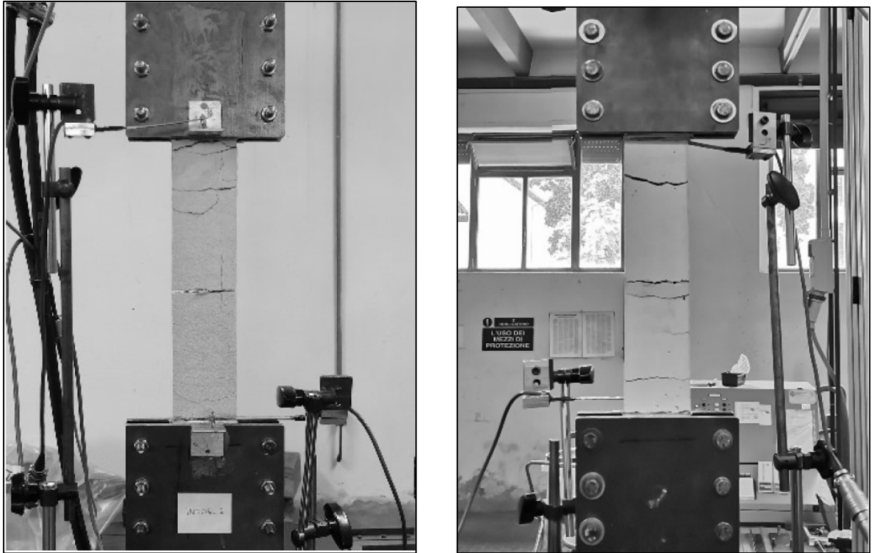
Fig. 3.26 Tipologia di rottura del coupon INT.06-C6.
