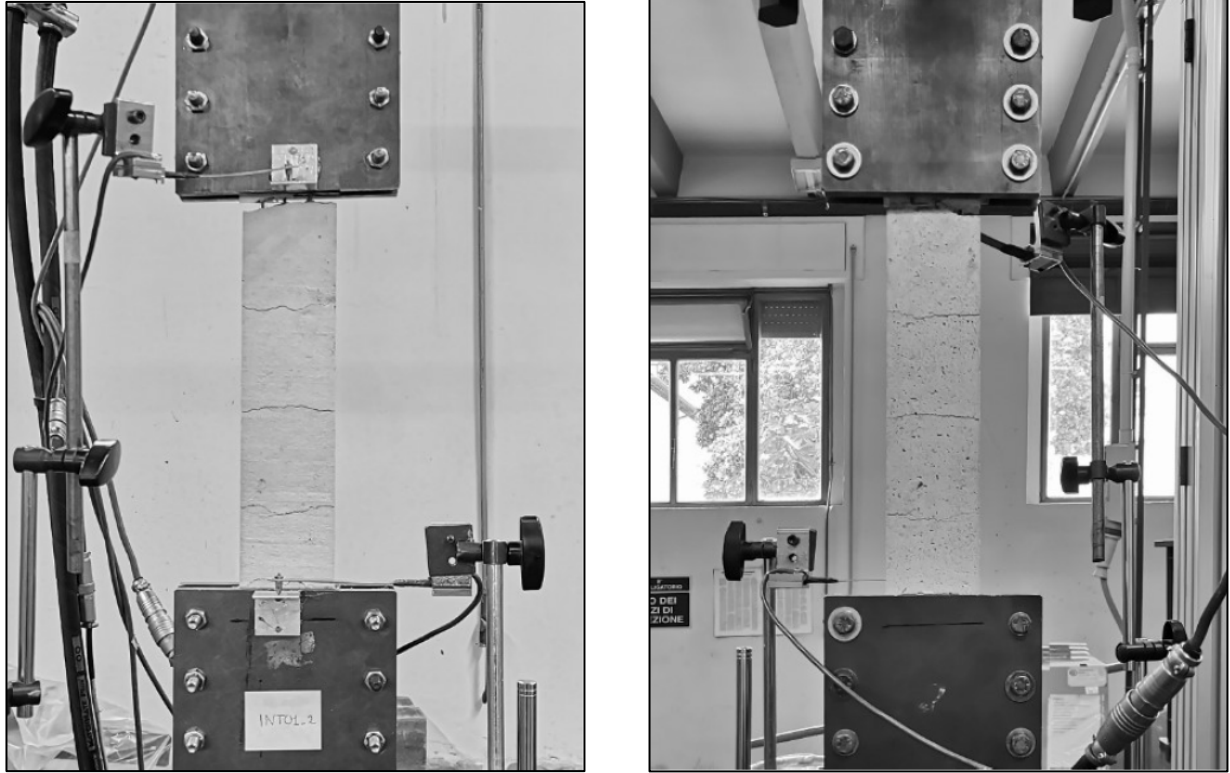
Fig. 3.8 Tipologia di rottura del coupon INT.01-C2.
