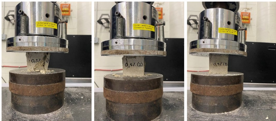
Fig. 12.5 Campioni di Mix.02 sottoposti a test di compressione.
