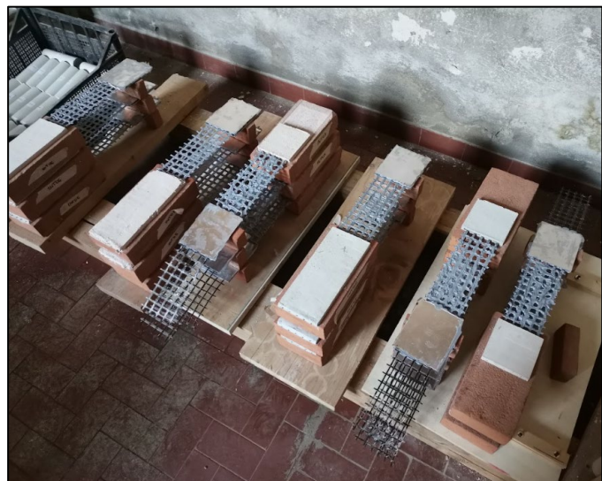
Fig. 4.3 Configurazione dei provini dopo la stesura della resina (a sinistra) e l'applicazione delle tabs metalliche (a destra).
