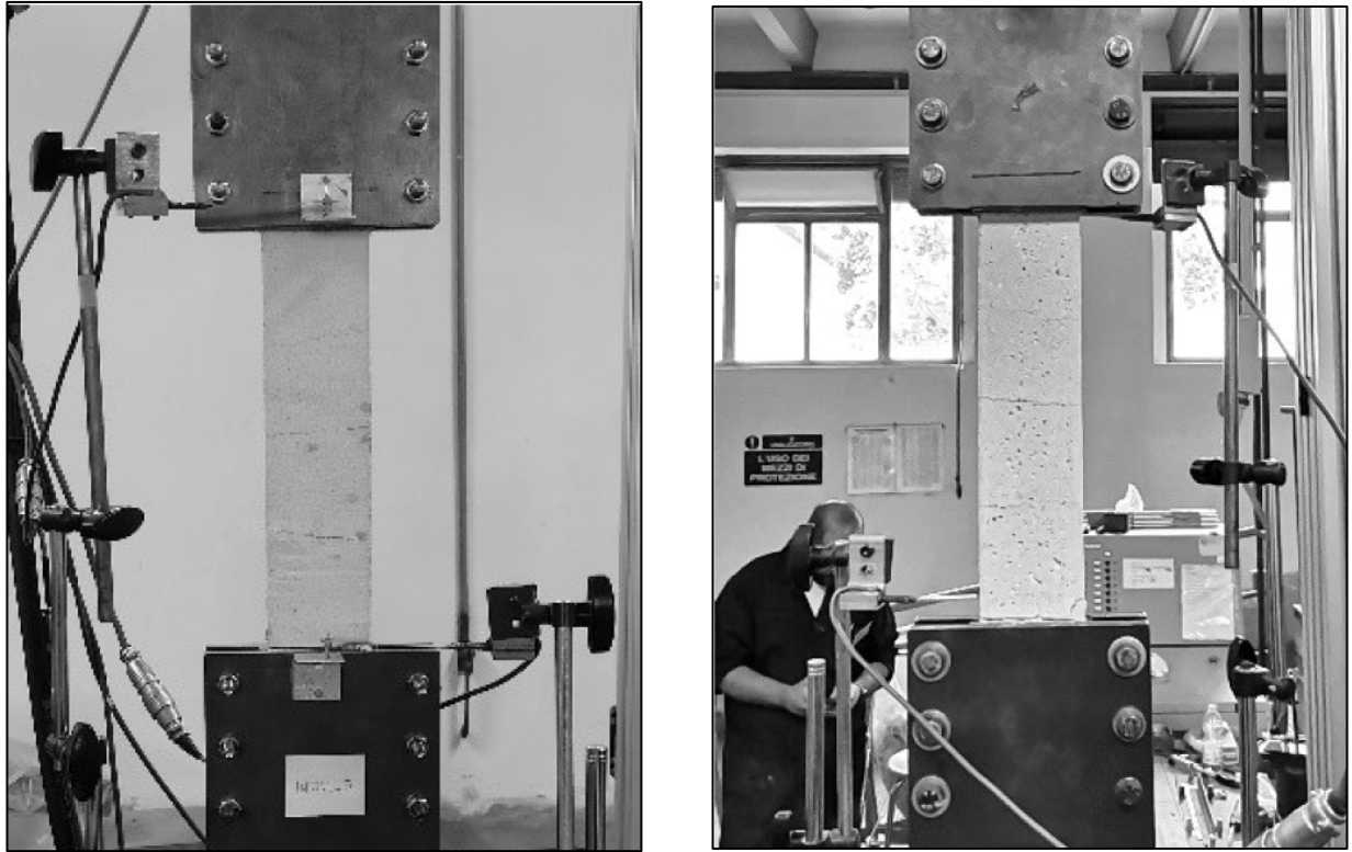
Fig. 3.11 Tipologia di rottura del coupon INT.01-C5.
