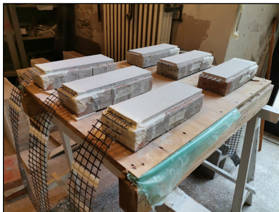
Fig. 4.29 Fase di preparazione dei pilastrini rinforzati.
