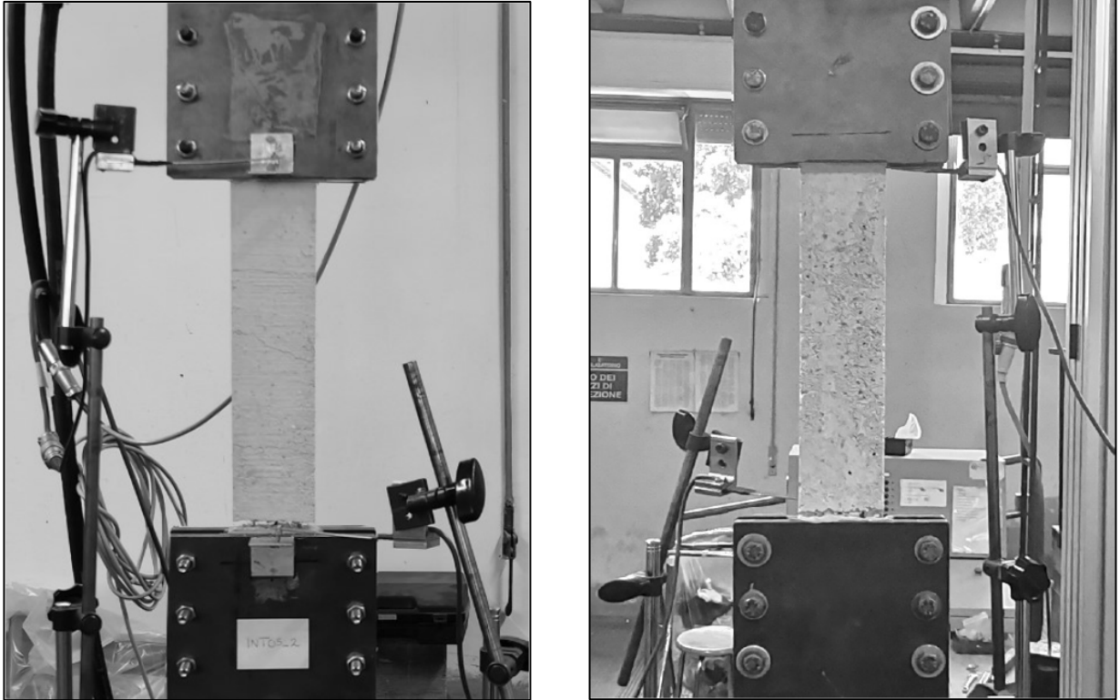
Fig. 3.15 Tipologia di rottura del coupon INT.05-C2.
