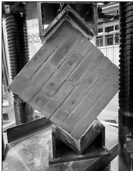
Fig. 5.5 Configurazione fronte (A) retro (B) del provino M1_DTNR dopo la rottura.
