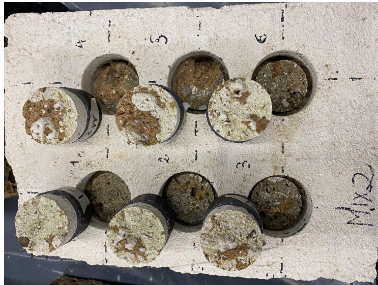
Fig. 13.24 Campioni di Mix.2- T sottoposti a test di adesione pull-off.
