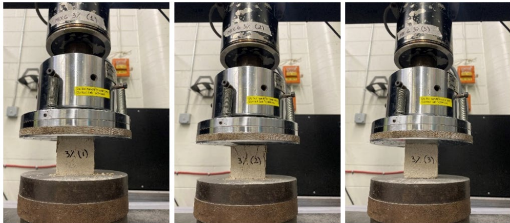
Fig. 12.13 Campioni di Mix.6 sottoposti a test di compressione.
