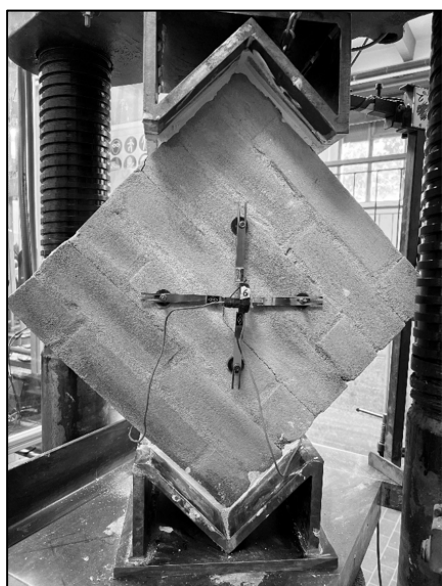
Fig. 5.11 Configurazione fronte (A) retro (B) del provino M3_DTR1 dopo la rottura.
