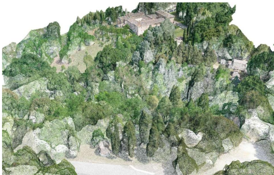
Figure 4. Il modello mesh della nuvola di punti della fotomodellazione del rilievo fotogrammetrico da Drone
