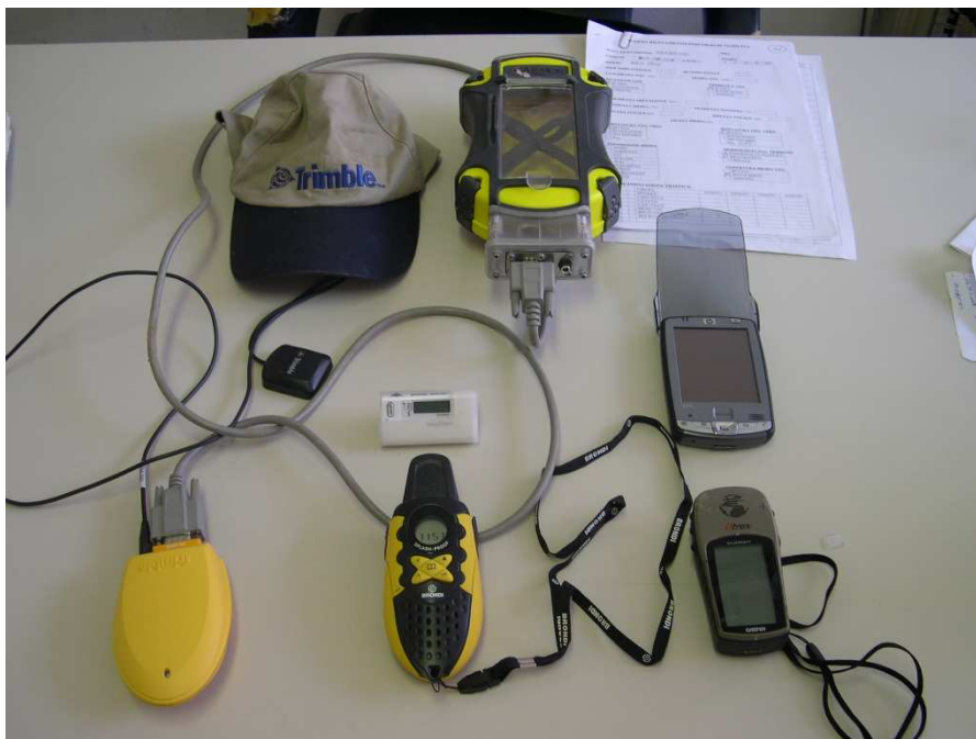
Figura 1. Strumentazione GPS utilizzata per i rilievi
