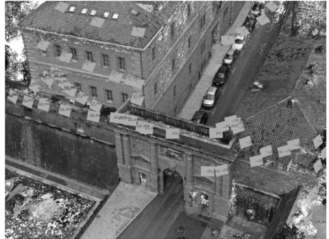
Fotogrammetria close range di Porta Zara, eseguita da drone, a completamento di quanto acquisito da terra.
