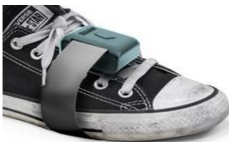
Figura 5: SensFoot batteria 4,2v/150mAh
