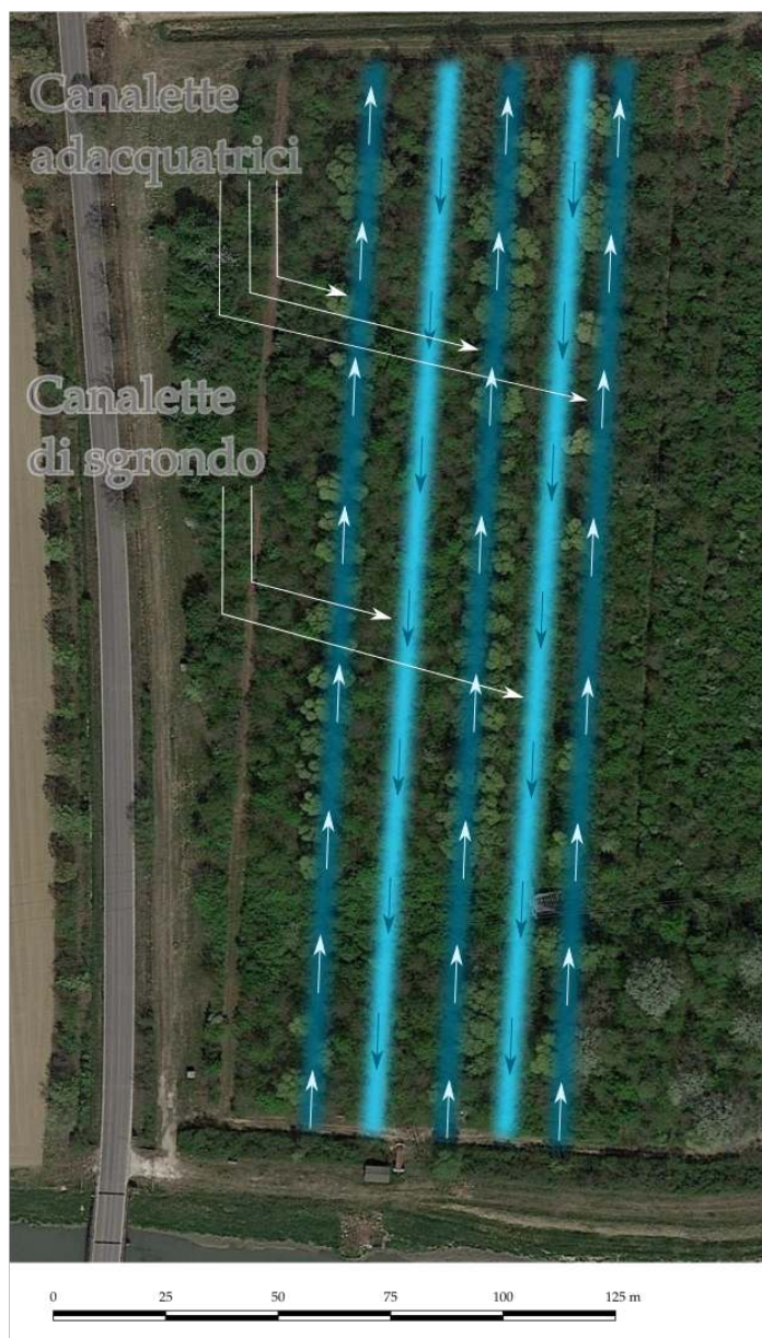
Figura 9.31: Schema del deflusso idrico nell'impianto Ni.Co.La.S.. Le canalette adacquatrici sono alimentate dalla piccola stazione di pompaggio visibile in basso, la quale a sua volta recupera le acque dal fiume Zero a sua volta più a sud. La baulatura del terreno fa sì che l'acqua venga drenata dalle due canalette di sgrondo che restituiscono l'acqua depurata al fiume. Tra la canaletta di adduzione di sinistra e centrale e la canaletta di sgrondo di sinistra, ci sono quattro filari di alberi. Tra la canaletta di adduzione di estrema destra, e quella di sgrondo immediatamente accanto vi è una unica fila d'alberi.
