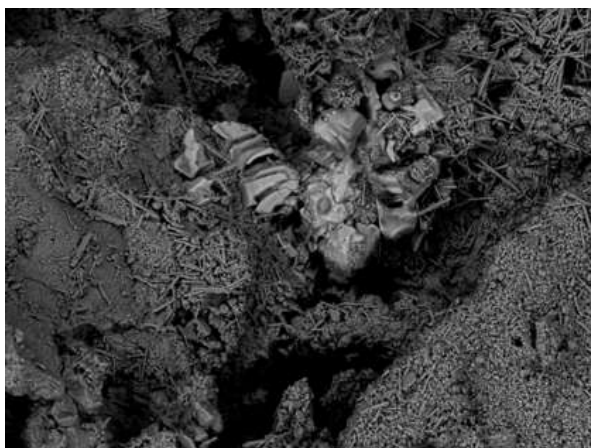
Fig. 7. Torre Zozzoli (TA). Immagine al SEM di un campione di pietra di un blocco del cantonale sinistro del prospetto ovest. I cristalli di Halite (NaCl) si dispongono nelle cavità e nelle porosità aperte. Le cristallizzazioni saline si presentano di tipo idiomorfo (tridimensionale). Riscontrate calciti aciculari in fase di cristallizzazione secondaria (sovrapposti all'halite).
