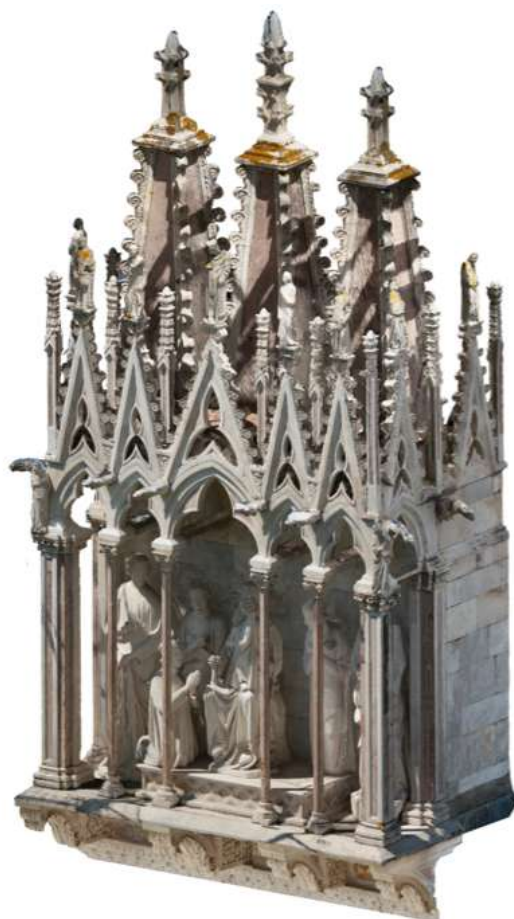
Fig. Modello tridimensionale, ottenuto dall'allineamento di scansioni e fotogrammi, utilizzato per l'elaborazione delle restituzioni grafiche e le analisi tematiche (elab. M. Bigongiari 2023).
