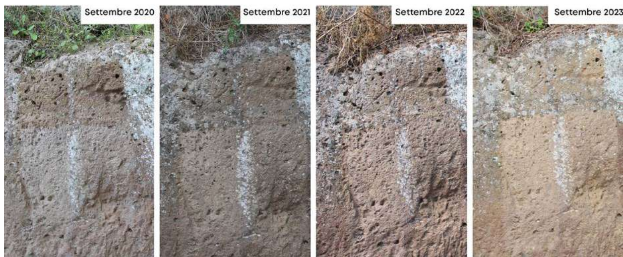
Fig. 5 Cerveteri, Via degli Inferi, il monitoraggio annuale delle applicazioni. Come si può notare i due quadrati nella parte alta di ciascuna foto, nell'arco di tre anni, sono tornati a ricoprirsi di biodeteriogeni, mentre i rettangoli posti sotto a ciascun quadrato sono rimasti, almeno a livello macroscopico, pressochè immutati. Questo perché la porzione superiore di ciascuna applicazione è stata trattata utilizzando silossani e nanosilici funzionalizzate con proprietà idrorepellenti ma privi di sostanze antivegetative, che sono state invece aggiunte nelle applicazioni sottostanti (foto T. Vagnarelli, 2020-2023)
