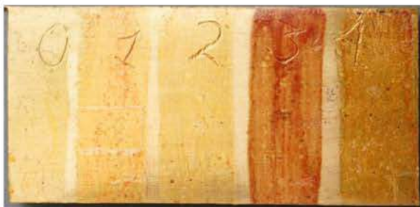
Fig. 4 Riproduzioni di patinature antiche su bronzo, ottenute con miscele di ingredienti desunti dalla trattatistica. Il set completo di questi provini è stato realizzato in occasione di una tesi della scuola di Alta Formazione e Studio dell'Opificio incentrata sulla bronzistica rinascimentale.
