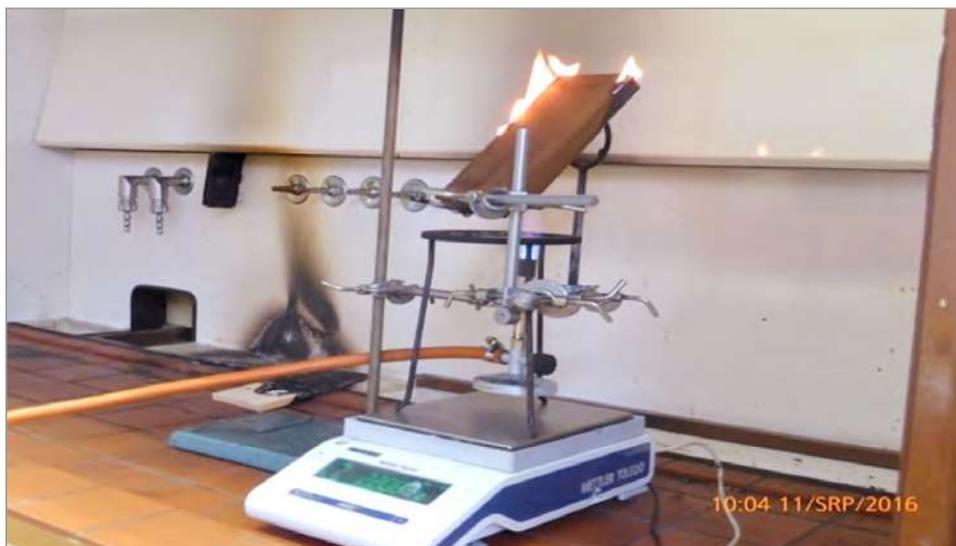
Set di prova a bruciatore con becco Bunsen a propano, supporti e bilancia tecnica (a un centigrammo di risoluzione). I dati della bilancia vengono acquisiti e registrati in tempo reale da un computer.
