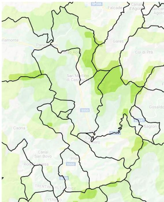
**Fig. 56 a) - Estratto mappa velocità media del vento a 25 m sul livello del terreno, unità di misura m/s. Fonte: Atlaeolico RSE**
