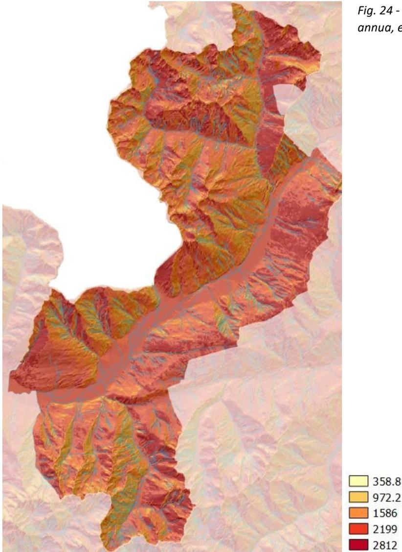
Fig. 24 - Carta della radiazione globale per m<sup>2</sup> annua, espressa in KWh/m<sup>2</sup>
