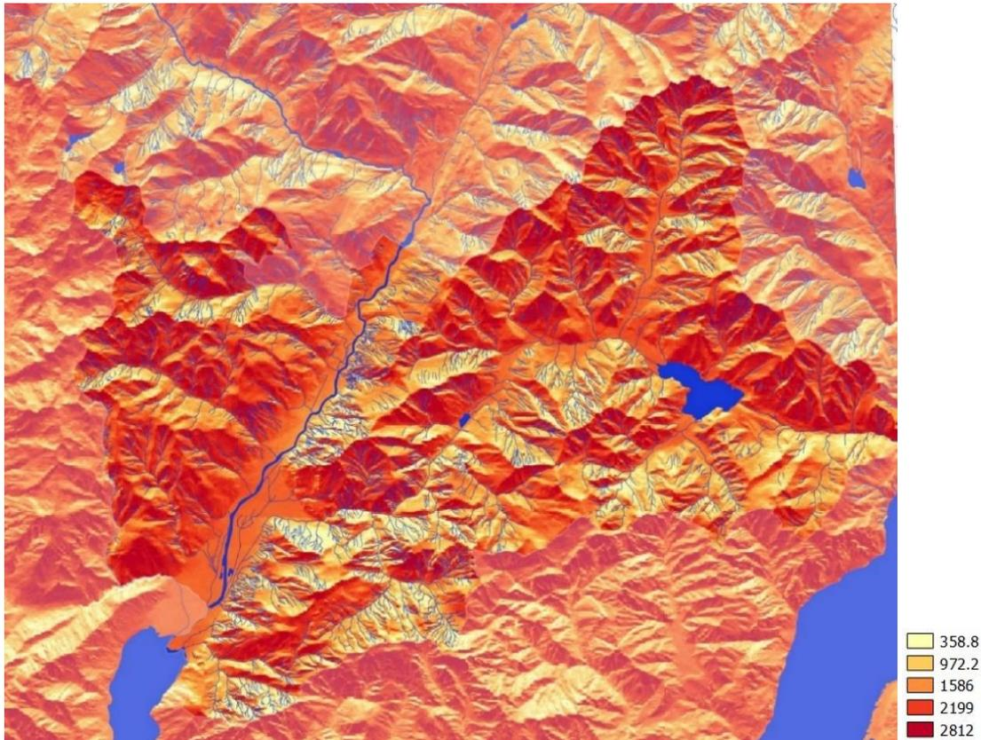
Fig. 47 – Carta della radiazione solare globale annuale, in  $\text{KWh/m}^2$ . Elaborazione in ambiente Qgis – Grass .
